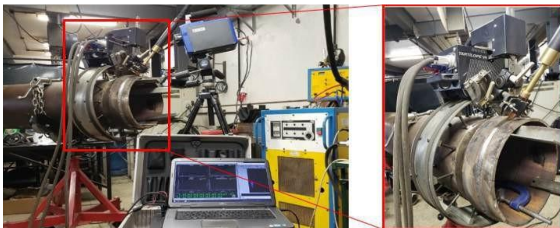
Figura 64 – Setup de laboratório. Fonte: o Autor. Em a) Bancada experimental; b) Detalhe do Tartilope e junta soldada.
