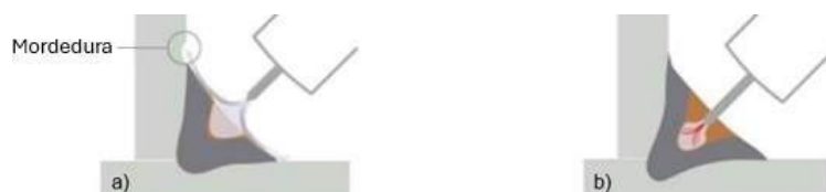
Figura 40 - Atuação do arco [8]. Em a) MIG/MAG convencional; b) DynaFlex-Arc .
