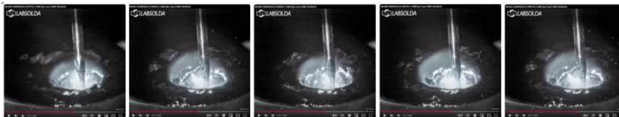
Figura 45 – Soldagem com a combinação K_s = 100 e K_d = 1 [85]. Vídeo disponível em: https://www.youtube.com/watch?v=RkpVX2cv1qc
