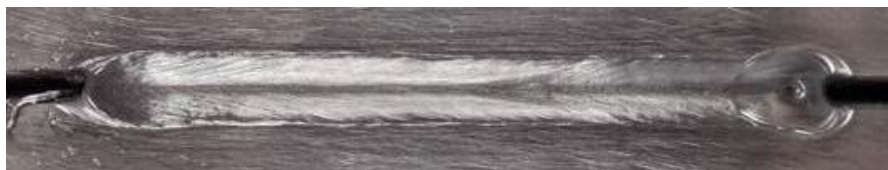
Figura 108 – Aspecto superficial da solda na sobrecabeça. Fonte: O autor.
