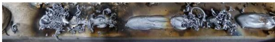
Figura 90 – Solda feita com o Dynaflex-Arc com a combinação K_s = 1 e K_d = 1 . Fonte: O autor.
