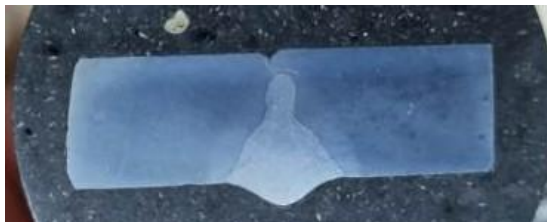
Figura 58 - Macrografia da secção transversal da solda realizada na sobrecabeça sem penetração total. Fonte: O autor.
