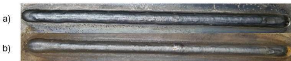
Figura 91 - Soldas feitas com o Dynaflex-Arc . Em a) K_s = 100 e K_d = 1 b) K_s = 200 e K_d = 1 . Fonte: O autor.
