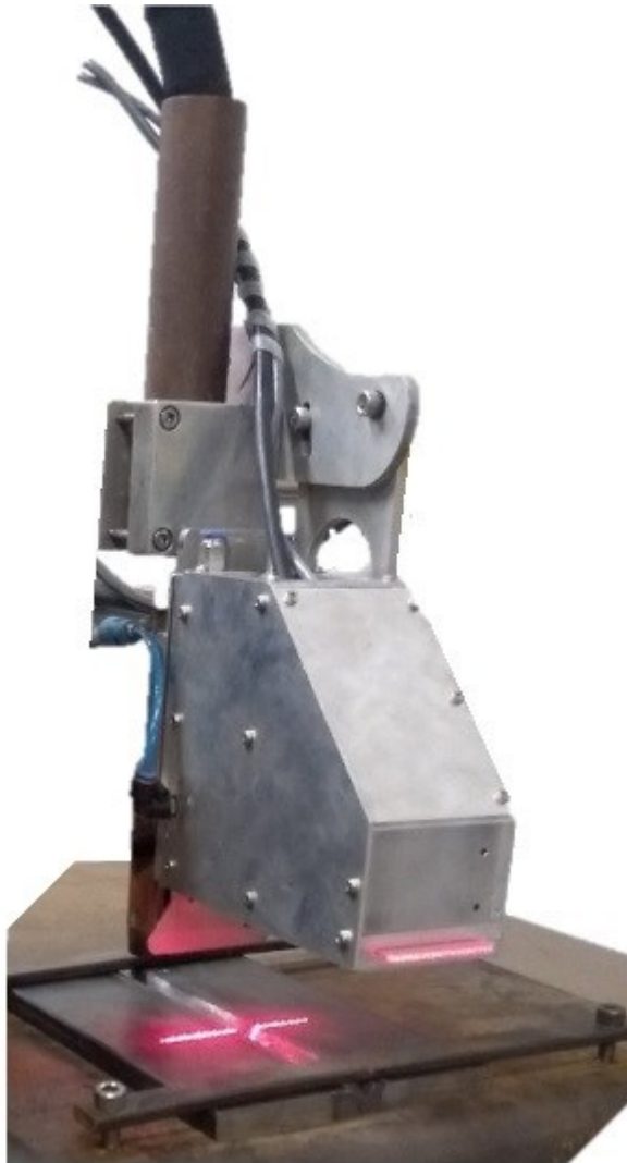
Figura 2.11 – STL de desenvolvimento nacional montado a uma tocha MIG automática.
