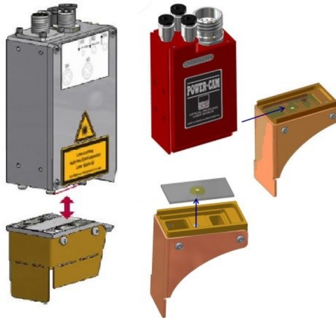
Figura 6.13 – Soluções para acomodação da janela de proteção óptica no STL3 (esquerda) e no STL2 (direita).
