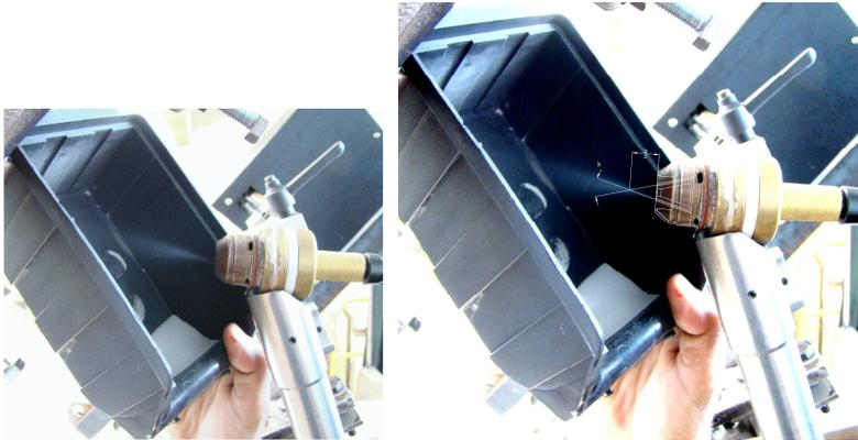
Figura 5.70. Comportamento da injeção de pó a 0° (vertical / horizontal) (sob as condições presentes no presente trabalho)
