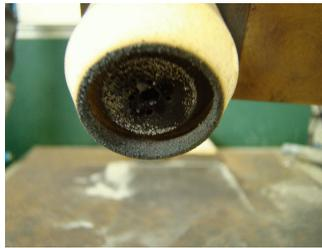
Figura 5.104. Contaminação da tocha por respingos oriundos da turbulência da poça metálica sob altos teores de  $N_2$  no gás de arraste
