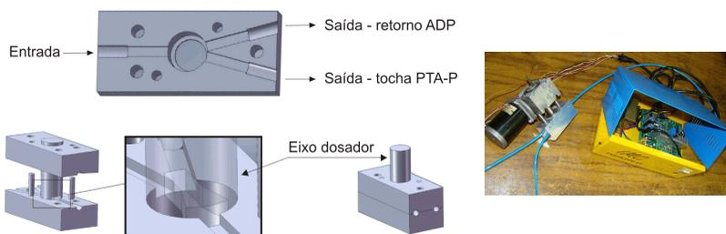
Figura 5.20. Pulsador de pó (uma entrada, vinda do ADP-2 e duas saídas: uma à tocha e outra de retorno ao silo do ADP-2) modelado e conjunto físico montado, com motor, redutor e respectivo driver
