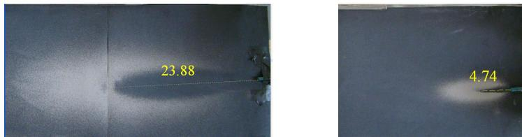
Figura 5.8. Distância (em mm) alcançada pelo jato de partículas com silo do alimentador modelo PM-PF-10 fechado (à esquerda.) e aberto (à direita), sob a mesma regulagem de vazão de gás (5 l/min, Ar)
