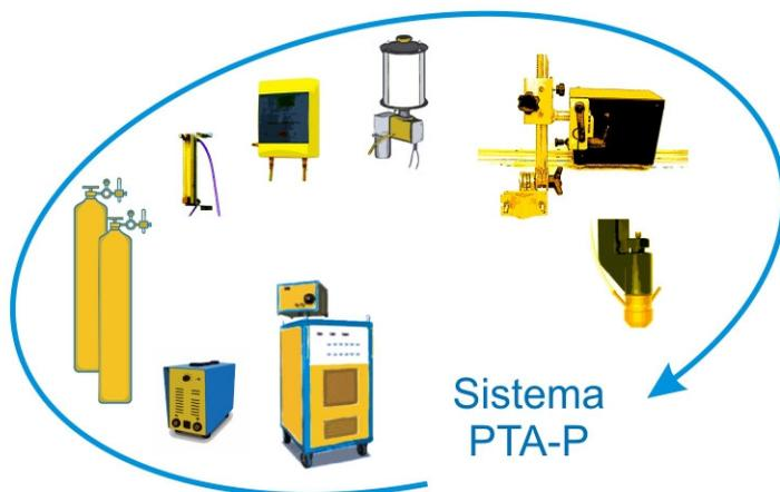
Figura 2.10. Esquema de um equipamento para soldagem PTA-P no modo automático
