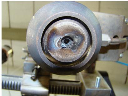
Figura 5.37. Tocha com injeção interna de pó e material aderido
