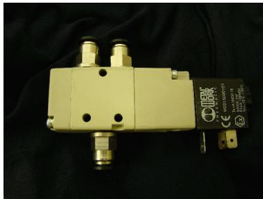
Figura 5.19. Válvula direcional comercial com conexões adaptadas, travada por incrustação de pó
