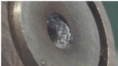
Figura 5.42. Canais obstruídos por material aderido à tocha com injeção interna de pó – material: LO3\* (triturado e misturado)
