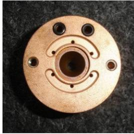
Figura 2.50. Bico constritor modificado, que permite regulagem independente de alimentação de material em pó para os orifícios injetores [65]
