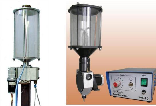
Figura 4.3. ADP desenvolvido em [9] (esquerda) e alimentador de pó para PTA-P comercial (direita)
