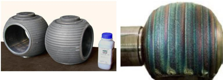
Figura 2.7. Exemplo de aplicação na indústria de petróleo e gás – válvula de esfera [45]
