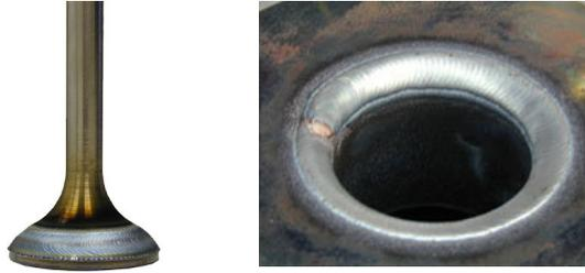
Figura 2.6. Exemplo de aplicação na indústria naval – válvula de motor marítimo e assento de válvula [45]
