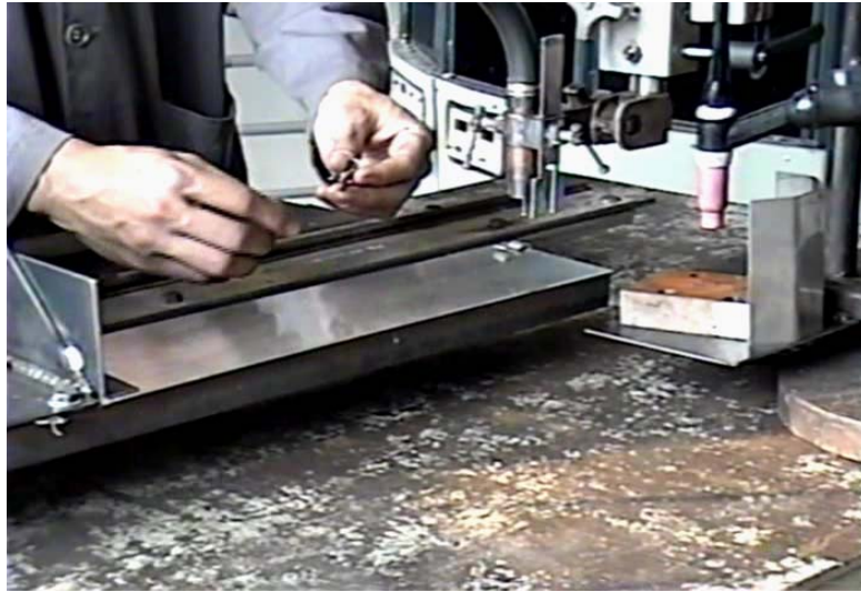
Figura 4.8 – Conjunto para ensaios com referência visual de comprimento de arco
