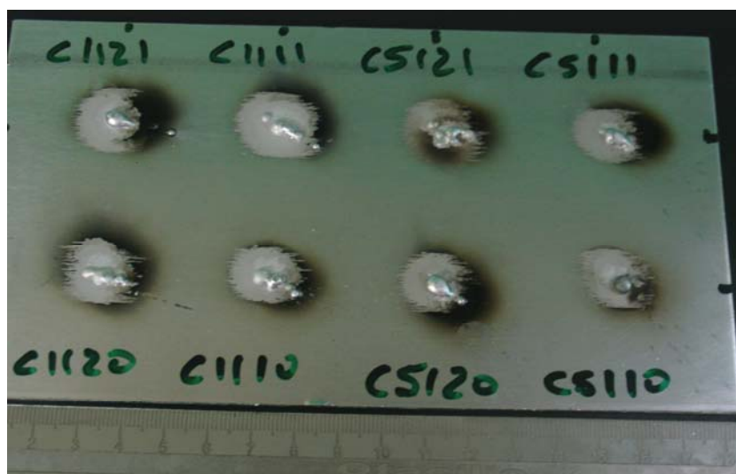
Figura 4.15 – Corpo de prova de ensaios de abertura com retorno do arame
