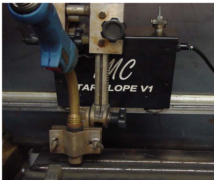
Figura 4.17 - Sistema de deslocamento de tocha (Tartílope)
