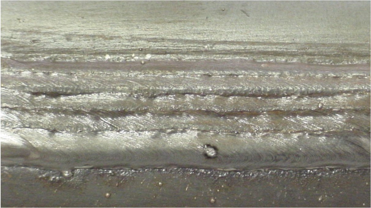
Figura 6.8 - Depósito de revestimento sobre tubo
