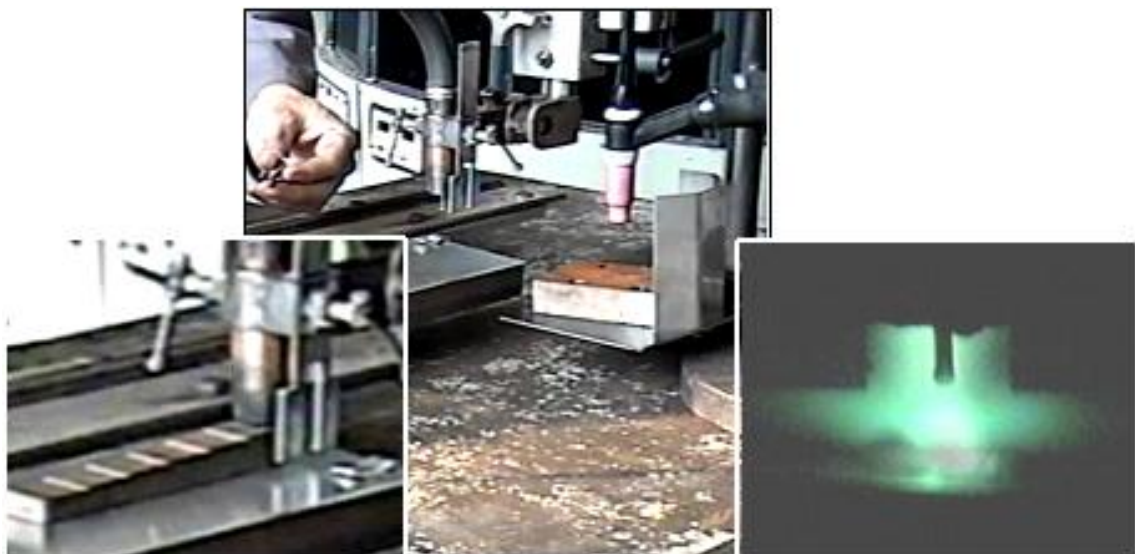
Figura 4.10 – Esquema dos ensaios com referência visual do comprimento de arco
