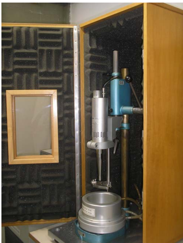
Figura 5.12 – Equipamento para ensaio de erosão por cavitação no interior da câmara acústica.
