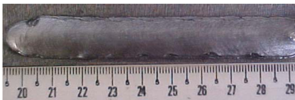
(Figura 6.2 - Aspecto superficial do cordão depositado na bancada de trabalho Starweld 300M/Deloro Stellite nas condições definidas nas tabelas 5.6 (taxa de deposição 0,58 kg/h).
