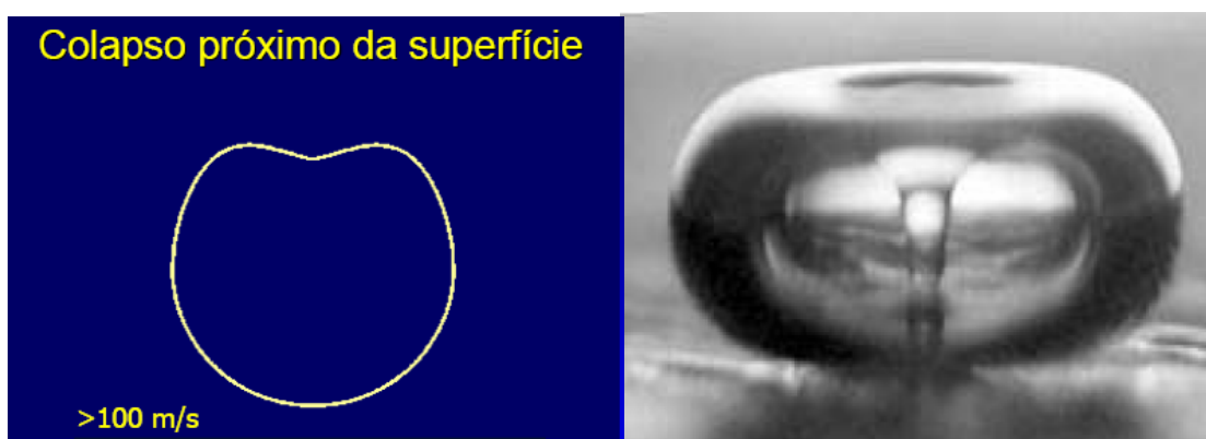
Figura 2.2- Formação do microjato de líquido através da bolha assimétrica. ( http://www.scs.uiuc.edu , 2007)
