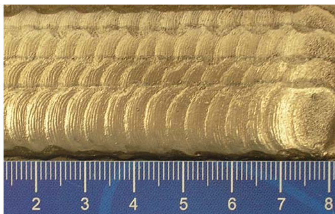
Figura 6.22 - Aspecto superficial do revestimento depositado com as ligas experimentais
