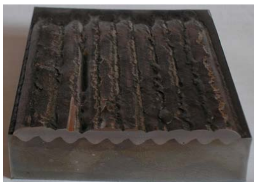
Figura 5.6 – Corpos de prova com deposição de uma camada de revestimento das ligas preliminares.
