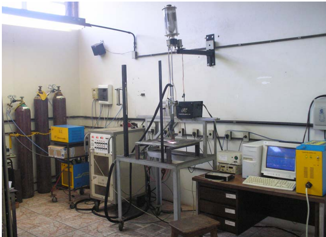
Figura 5.2 – Bancada de soldagem Inversal 300/IMC
