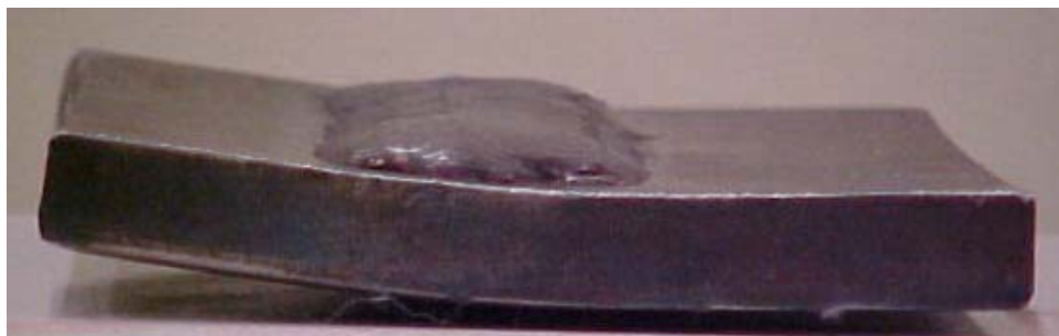
Figura 6.23 - Deformação do corpo de prova depositado com as ligas experimentais (espessura do substrato = 12,7 mm)
