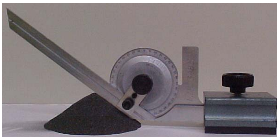
Figura 5.5 – Ângulo de empilhamento da liga experimental.
