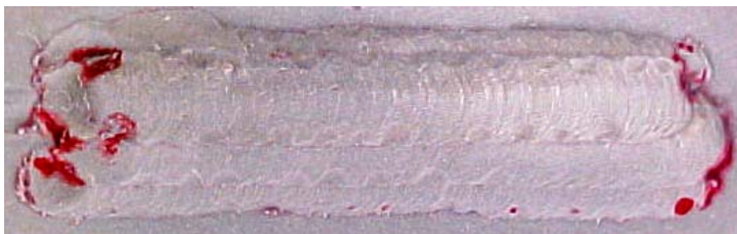
Figura 6.24 - Ensaio com líquido penetrante no corpo de prova depositado com as ligas experimentais.
