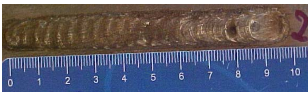
(b) Gás de proteção 15,0 l/min; gás de arraste 1,5 l/min; gás de plasma 2,0 l/min
