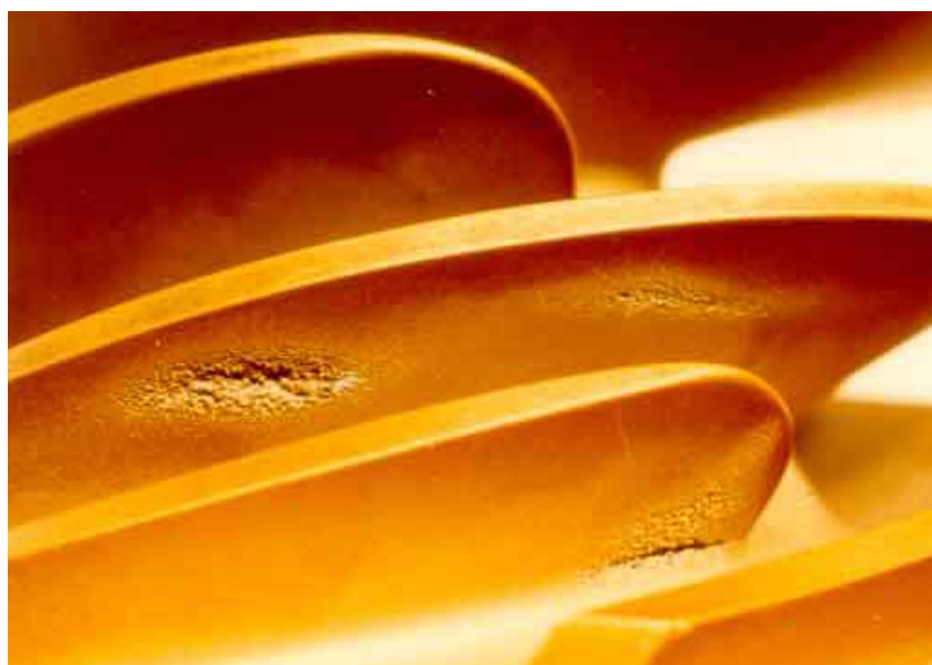
Figura 2.7 - Danos de cavitação nas pás de uma bomba de fluxo construída em liga de alumínio (Brennen, 1995).
