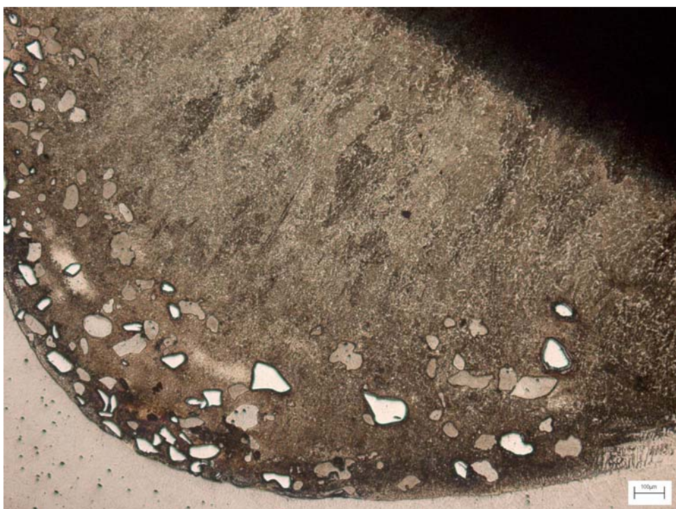
Figura 6.10 - Macrografia dos revestimentos das ligas preliminares depositadas segundo os parâmetros da tabela 5.6 (I=100A; E= 17kJ/cm).
