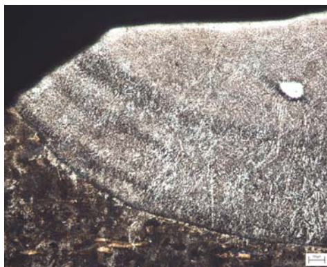
Figura 6.15 – Micrografia mostrando a presença de partícula não fundida. Depositado segundo os parâmetros das tabelas 5.7 e 5.8 para o CP3.
