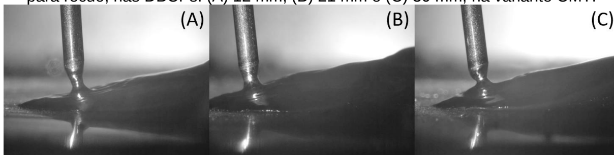
Figura 99 - Momento de inversão do sentido de alimentação de arame, de avanço para recuo, nas DBCPs: (A) 12 mm, (B) 21 mm e (C) 30 mm, na variante CMT.
