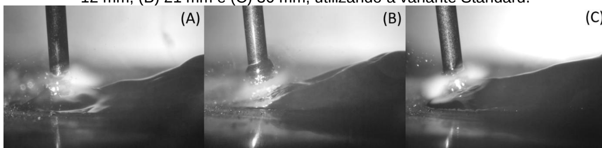
Figura 86 - Momento de desprendimento da gota do arame eletrodo nas DBCPs: (A) 12 mm, (B) 21 mm e (C) 30 mm, utilizando a variante Standard.
