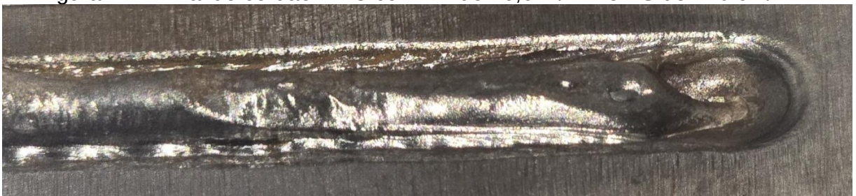
Figura 72 – Final do cordão PMC com VA de 16,6 m/min e VS de 120 cm/min.
