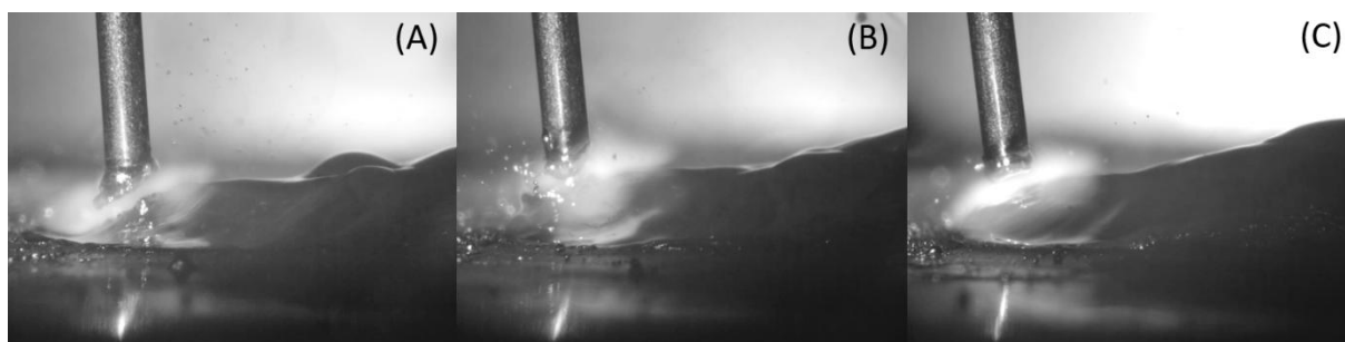
Figura 81 – Momento de desprendimento da gota do arame eletrodo nas DBCPs: (A) 12 mm, (B) 21 mm e (C) 30 mm, utilizando a variante convencional.
