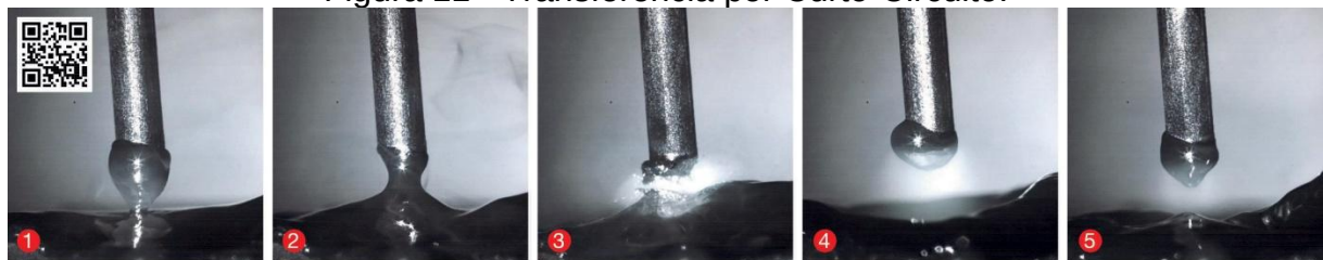
Figura 11 - Transferência por Curto-Circuito.
