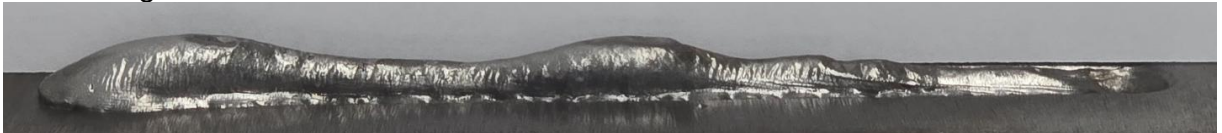
Figura 71 – Cordão PMC com VA de 16,6 m/min e VS de 120 cm/min.
