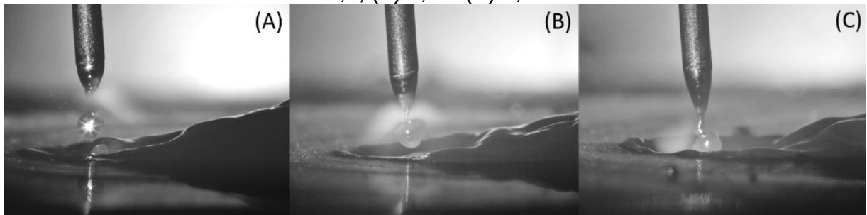
Figura 61 – Variantes PMC nos instantes de destacamento da gota. VA (m/min): (A) 4,1; (B) 5,9 e (C) 8,3.
