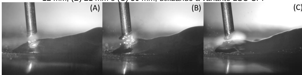
Figura 94 - Momento de desprendimento da gota do arame eletrodo nas DBCPs: (A) 12 mm, (B) 21 mm e (C) 30 mm, utilizando a variante LSC CP.
