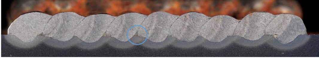
Figura 57 - Detalhamento de uma inclusão de sílica por MEV com ampliação de 250 x
