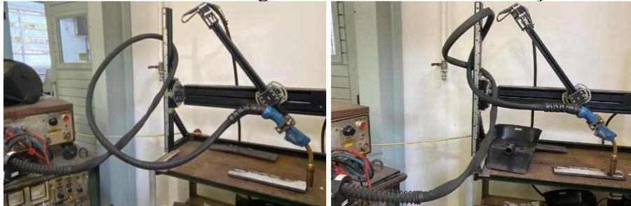
A avaliação desses ensaios foi feita em tempo real, analisando a regularidade do processo e travamentos perceptíveis no arame. Também foi realizada a de medição da velocidade de alimentação (ponto de referência da medição utilizado foi entre o desentortador e os roletes), através do Sistema de Aquisição Portátil (SAP), que conseguiu registrar reduções e oscilações bruscas.
