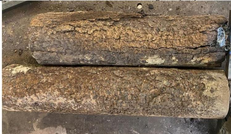
As peças escolhidas apresentam uma camada expressiva de óxidos em sua superfície, o que impede a passagem de corrente elétrica e dificulta a abertura do arco elétrico. Portanto, na peça em maior estado de degradação foi soldada uma chapa limpa de ASTM A36 para realizar a abertura do arco e avaliar somente se o mesmo conseguiria se manter aberto ao longo do comprimento da peça.
