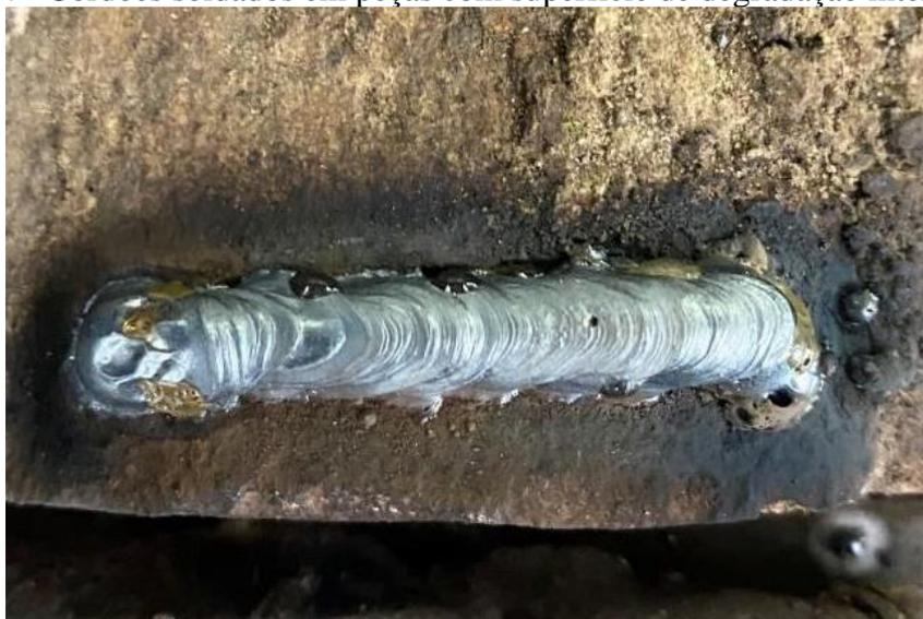
Figura 35 - Cordão soldado em peça com superfície de degradação intermediária, buscando arrastar o arco aberto para regiões em pior condição superficial
