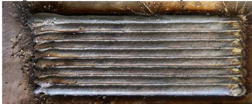
Um modo de solucionar essa problemática é aplicar uma energia maior por um tempo curto, até que o arco consiga se estabelecer e iniciar o processo. Foram realizados alguns testes para determinar um tempo e uma tensão de abertura, e encontrou-se a parametrização de 25,5 V por 2,5 s, que auxiliou a regularizar o início da operação, como pode ser visto na Figura 25.
