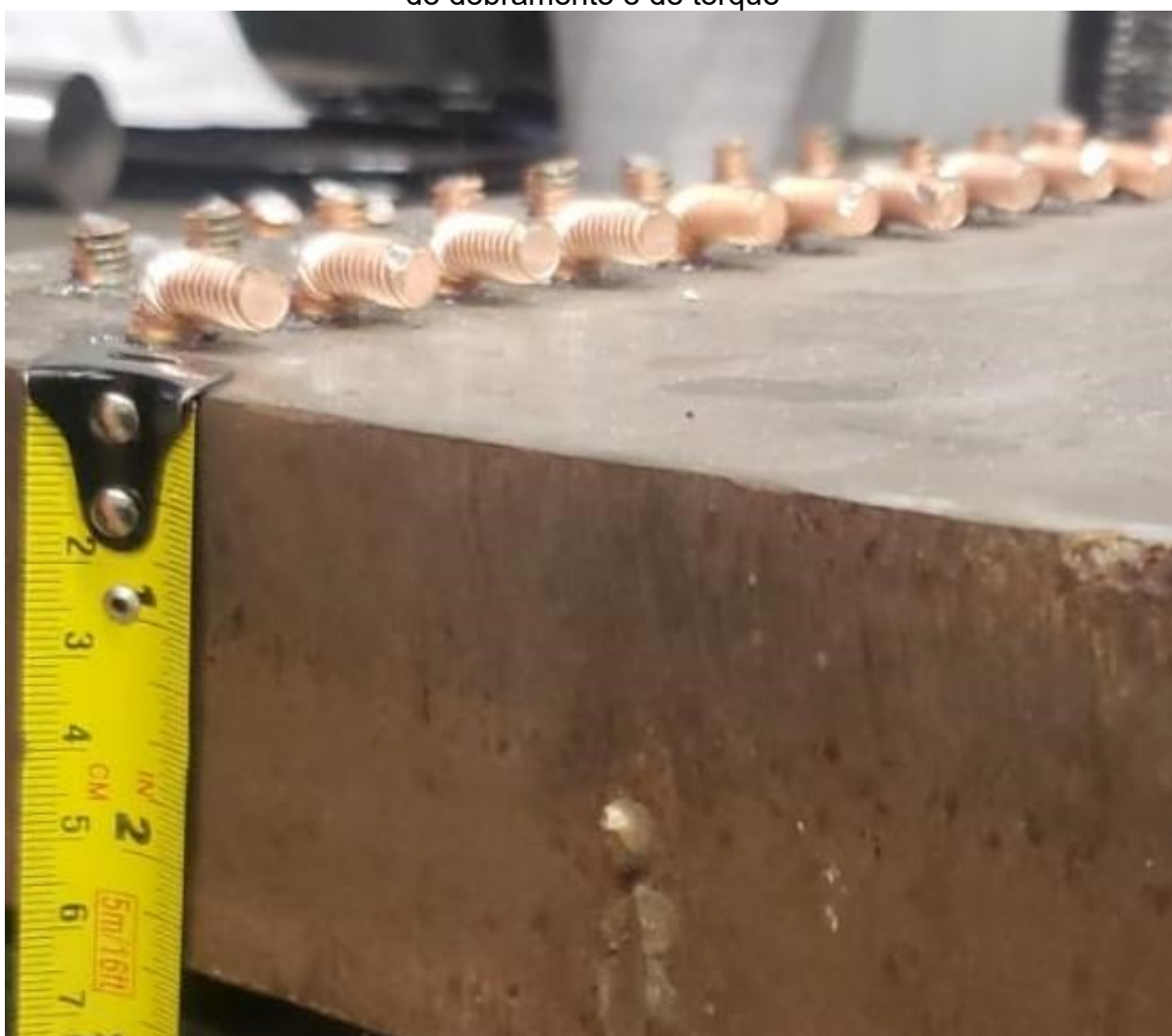
Figura 65 – Pinos M8 soldados na chapa de 63,5 mm de espessura após os testes de dobramento e de torque
