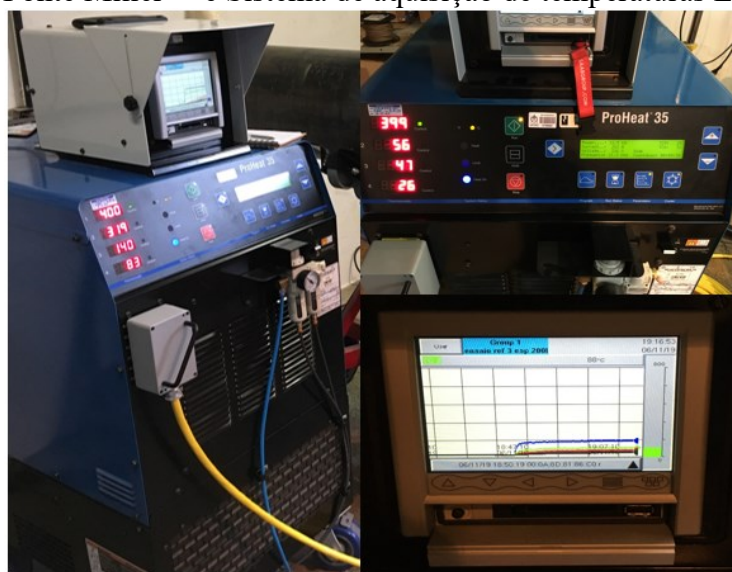
Figura 23. Fonte Miller™ e Sistema de aquisição de temperaturas Eurotherm™
