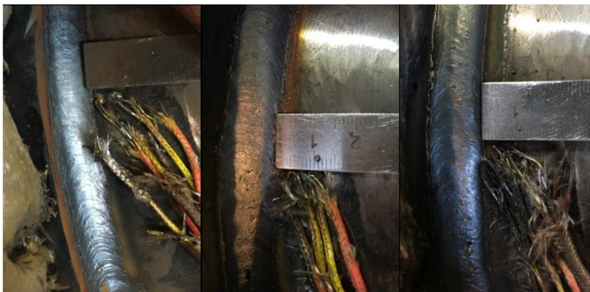
Figura 95. Soldagem orbital da dupla-calha aquecida por indução utilizando o processo MIG/MAG – PCA. Da esquerda para a direita: 1º, 2º e 3º passes
