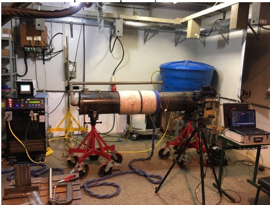
Figura 71. Ensaio de aquecimento por indução em bancada com fluxo de água
