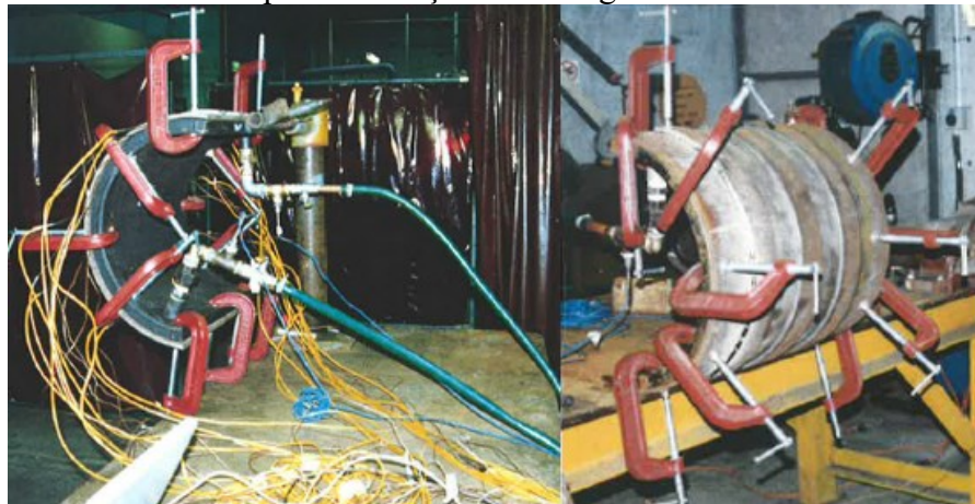
Figura 7. Bancada utilizada para simulação de soldagem de calhas em dutos em operação
