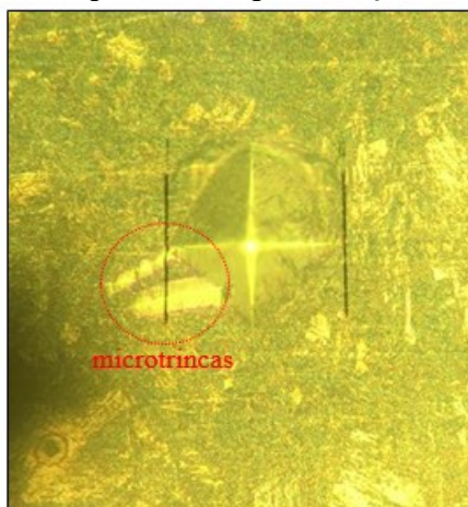
Figura 114. Microtrincas em indentação na amostra soldada com a variante PCA sem aquecimento por indução
