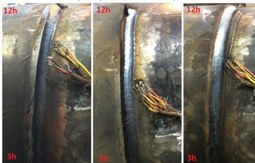
Figura 89. Soldagem orbital da dupla-calha utilizando o processo MIG/MAG Pulsado, da esquerda para a direita: 1º, 2º e 3º passe
