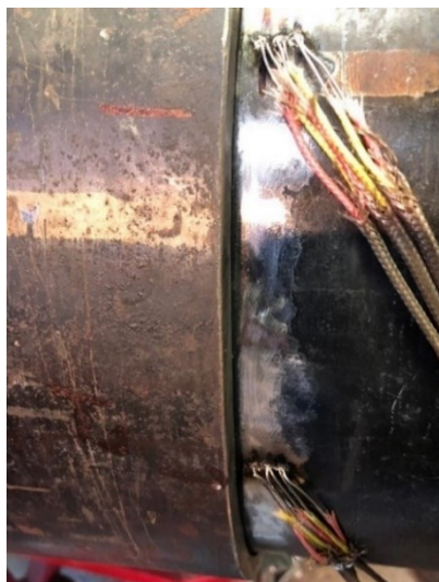
Figura 51. Dupla calha posicionada para soldagem e disposição de termopares para aquisição do ciclo termico
