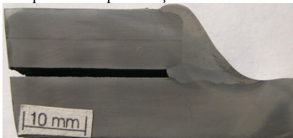
Figura 102. Macrografia da junta soldada utilizando o processo MIG/MAG – PCA assistido de pré-aquecimento por indução em bancada inclinada
