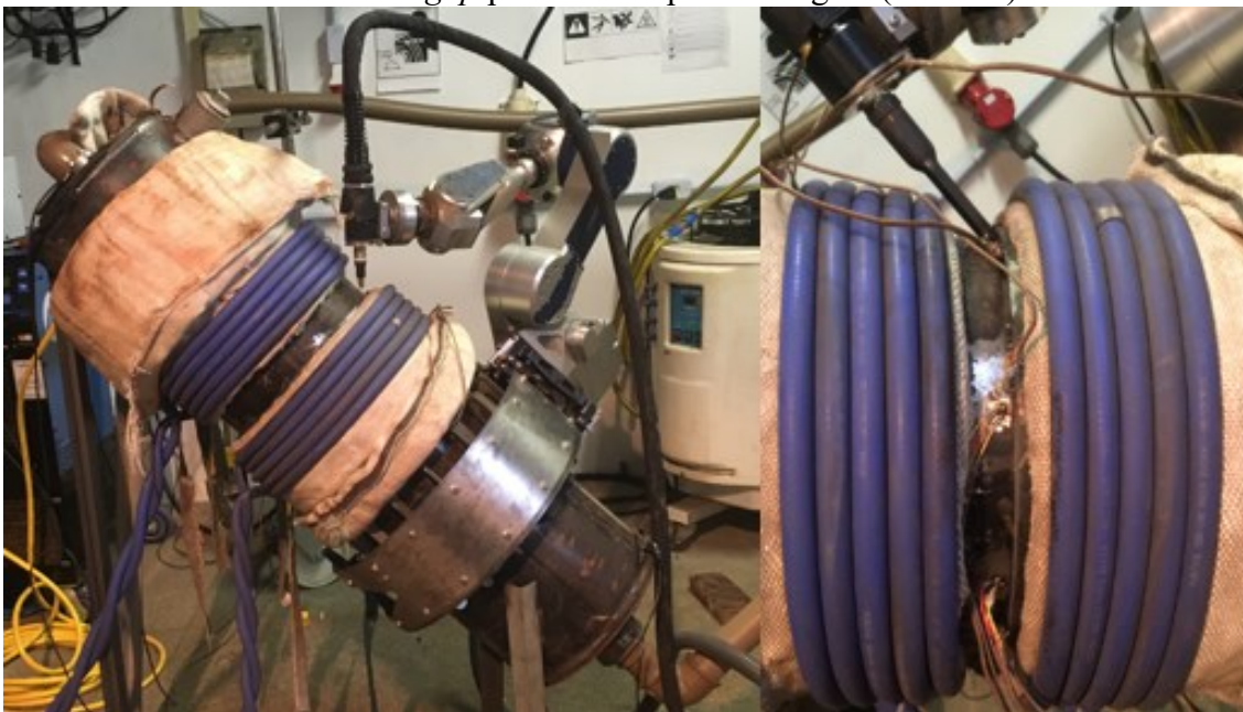
Figura 49. Bancada inclinada com duas bobinas de aquecimento posicionadas (à esquerda) e bocal narrow gap posicionado para soldagem (à direita)
