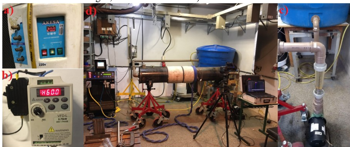
Figura 25. Elementos de composição da bancada sendo a) chiller b) inversor de frequência c) caixa d'água, bomba e rotâmetro d) vista frontal da bancada
