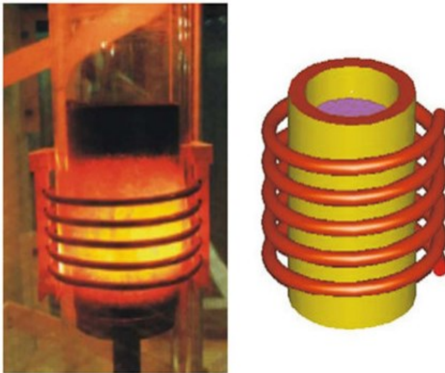
Figura 20 - Forno de indução simulado no estudo Fonte: Djellabi e Latreche(2014)
