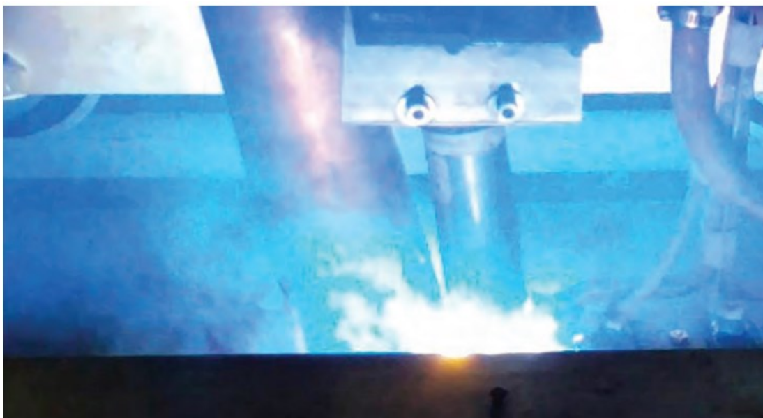
Figura 14 - Soldagem HiDep em chapa de 5/8" de Marine Steel, junta de topo com gap 1/8"
