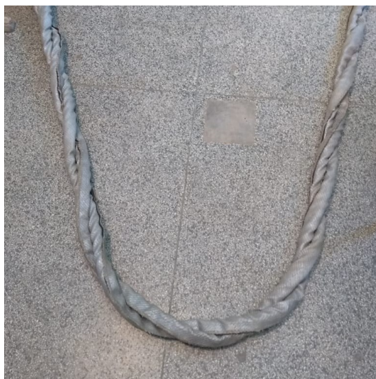
Figura 32 - Cabos entrelaçados fora da bobina
