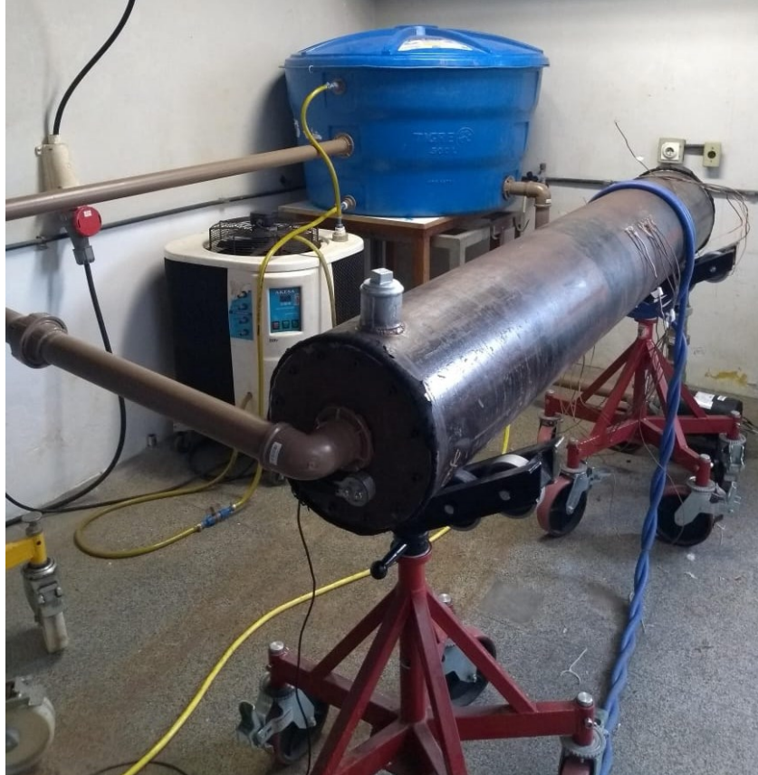
Figura 25 - Visão geral do circuito hidráulico da bancada de ensaios
