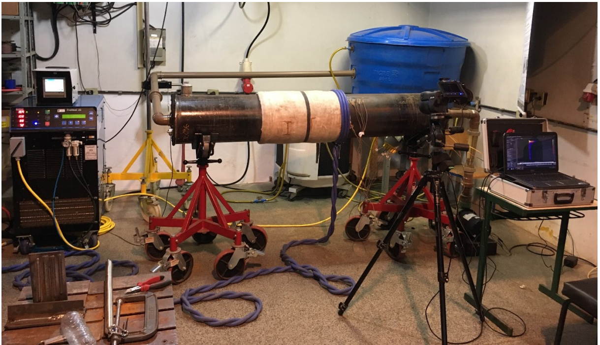
Figura 33 - Bancada de experimentos para os ensaios com escoamento
