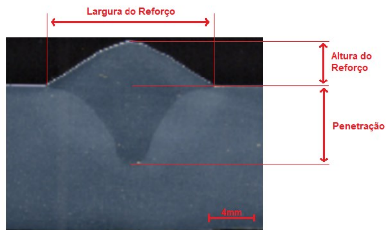
Figura 63 – Elementos analisados nas macrografias das soldas realizadas.
