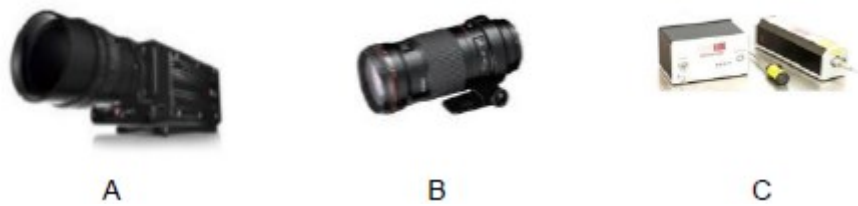
Figura 55 – Principais equipamentos necessários para filmagem de alta velocidade (A- câmera de alta velocidade; B- Lente; C- Sistema de iluminação LASER)
