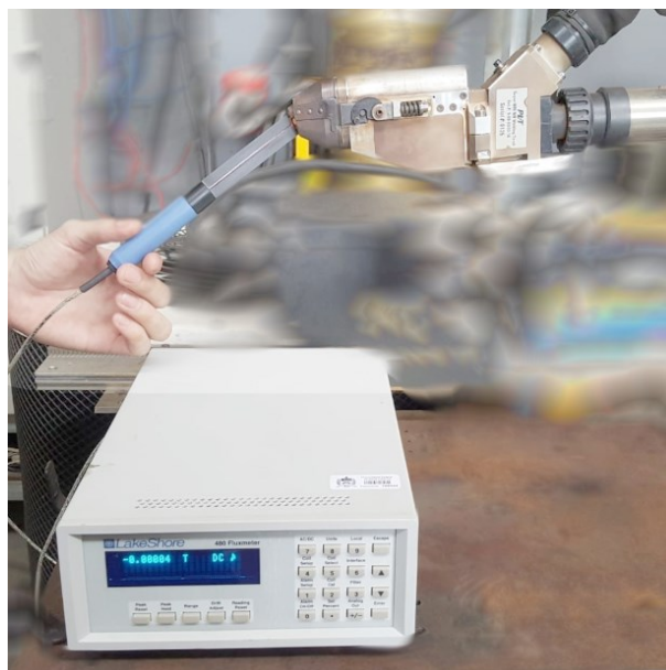
Figura 61 – Medição do campo magnético presente no bocal da tocha no modo teste.
