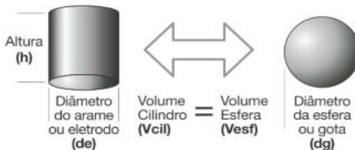
Figura 2.9 - Representação da equivalência entre os volumes na transferência metálica [1].
