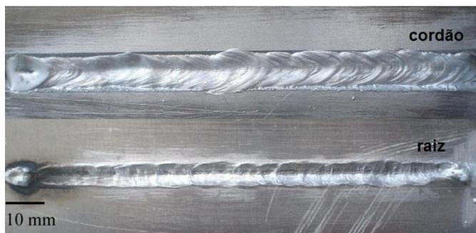
Figura 32 – Problema na soldagem de raiz, posição vertical ascendente, modo MIG Convencional
