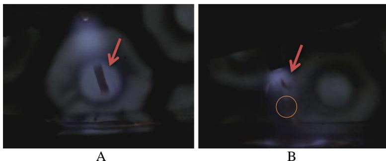
Figura 56 - Comportamento da transferência metálica ( $I_p=350$  A;  $t_p=1,2$  ms); A – Alongamento da gota no conjunto 11 com dg 1,2mm; B – Formação de respingos no conjunto 12 com dg = 1,44
