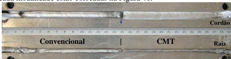
Figura 39 – Soldagem de raiz em alumínio naval comparando MIG Convencional e CMT na posição plana
