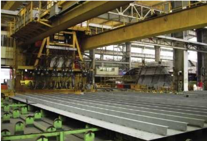
Figura 3-Linha automática para a fabricação de painéis [4]
