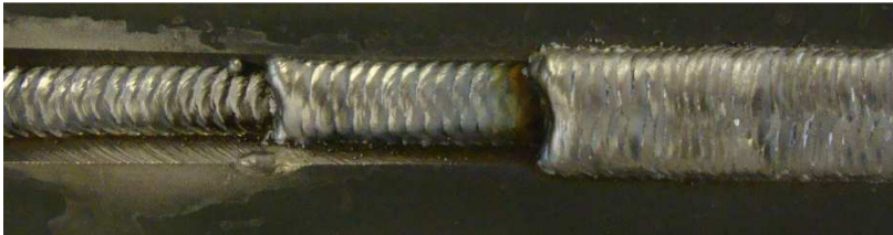
Figura 60 - Resultado da soldagem de passes da junta da figura 58
