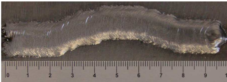
Figura 56 - Correção da linha de simetria do tecimento
