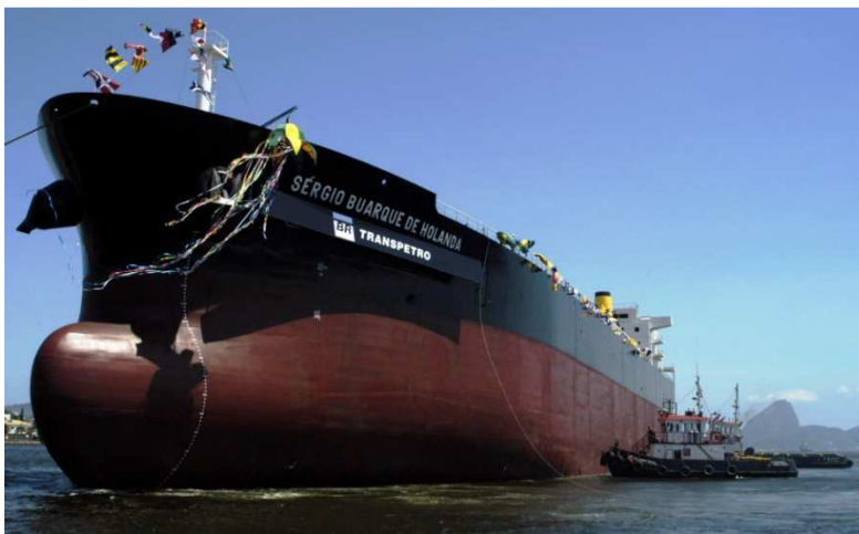
Figura 1- Terceiro navio petroleiro entregue à Transpetro com 183 metros de comprimento e 48,3 mil toneladas de capacidade [6]
