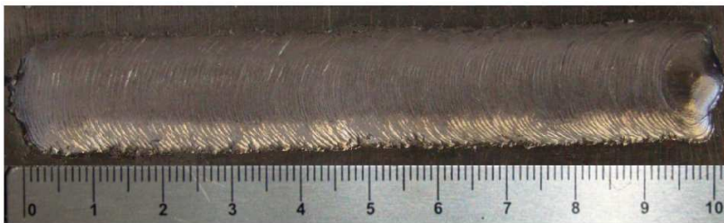
Figura 53 - Cordão de solda realizado com alta velocidade de tecimento
