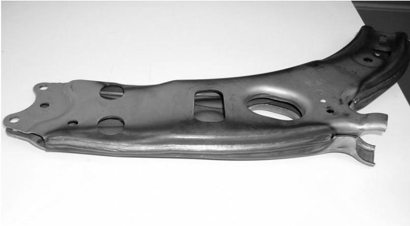
**Figura 49 - Componente do conjunto de suspensão de automóvel soldado com o processo TIG (Velocidade de soldagem 90 cm/min; Corrente: 340 A; Tensão do arco: 19 V; Gás de proteção: Ar+15%H<sub>2</sub>)**
