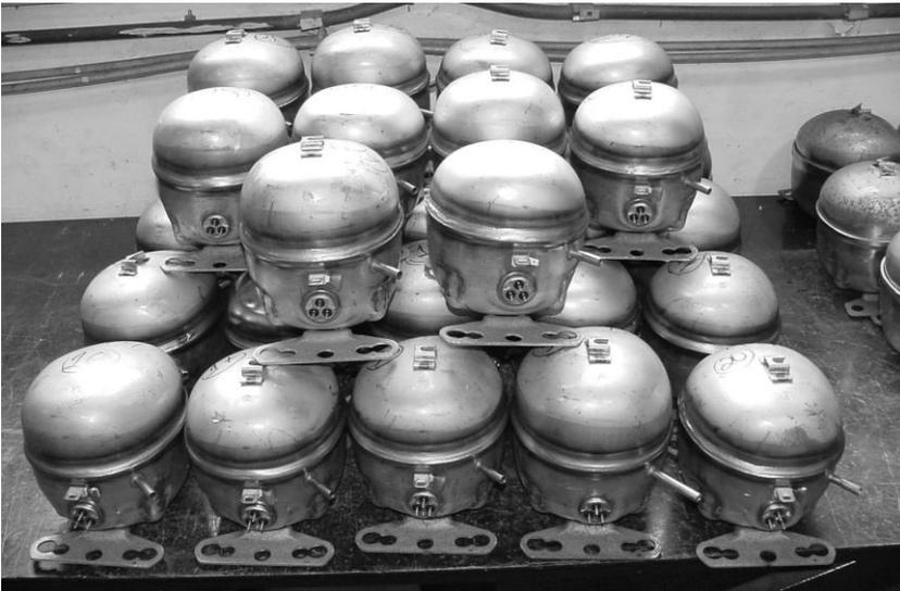
**Figura 45 - Compressores soldados nos testes realizados**
