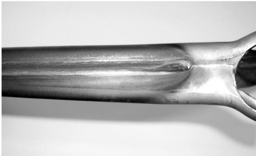
**Figura 50 - Detalhe do aspecto da solda de componente do conjunto de suspensão de automóvel soldado com o processo TIG. (Velocidade de soldagem 90 cm/min; Corrente: 340 A; Tensão do arco: 19 V; Gás de proteção: Ar+15% $H_2$ )**
