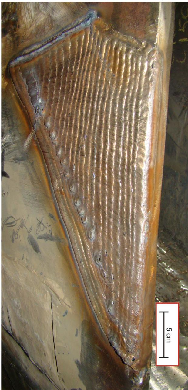
Figura 5.24 – Depósito de Inox 316L com 2 camadas
