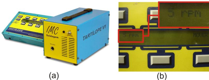
Figura 3.2 – Controle do ADP de Fuso: a) gabinete e IHM; b) opção de controle de rotação do fuso na IHM
