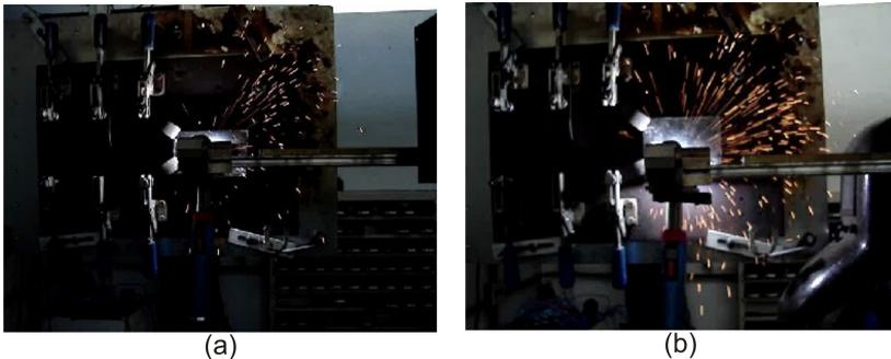
Figura 5.18 – Soldagem em parede vertical: a) soldagem com ADP VR-F empregando 2,5 l/min; b) soldagem com ADP de Tambor empregando 5,0 l/min
