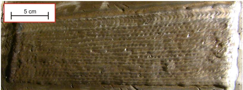
Figura 5.26 – Depósito de Cavitec Pó com 2 camadas
