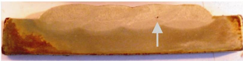
**Figura 32 - Revestimento com falta de fusão.**
