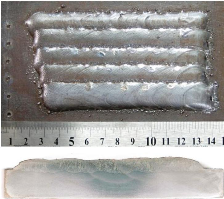
**Figura 30 - Geometria de uma camada de solda obtida no processo MIG/MAG-PS com 1/3 de polaridade CC+.**
