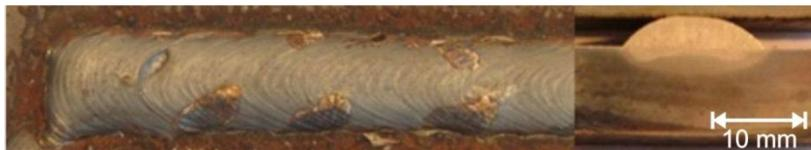
**Figura 25 - Cordão de solda obtido com 50% de polaridade negativa.**
