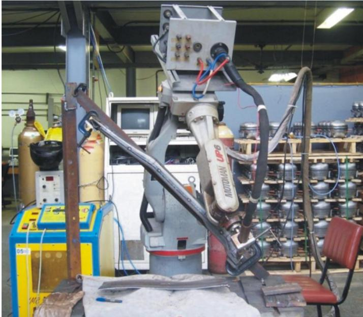
**Figura 22 - Bancada de ensaios da soldagem de juntas**
