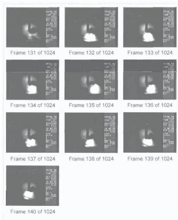
**Figura 4 – Imagens da gota metálica sendo repelida e da movimentação do ponto catódico [14].**
