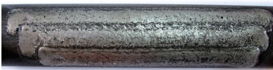
Figura 4-6 – Tubo revestido com o processo PTAP e INCONEL 625 na posição plana
