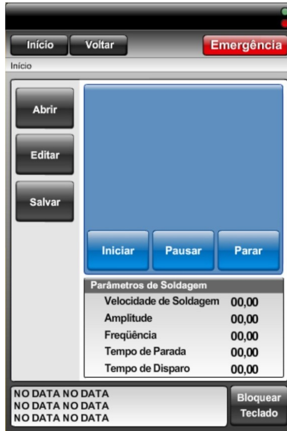
Figura 3-45 – Tela final para acompanhamento da soldagem
