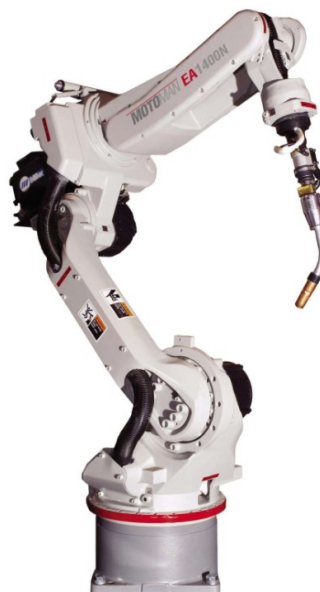
Figura 1-5 – Robô antropomórfico de 6 graus de liberdade (6)
