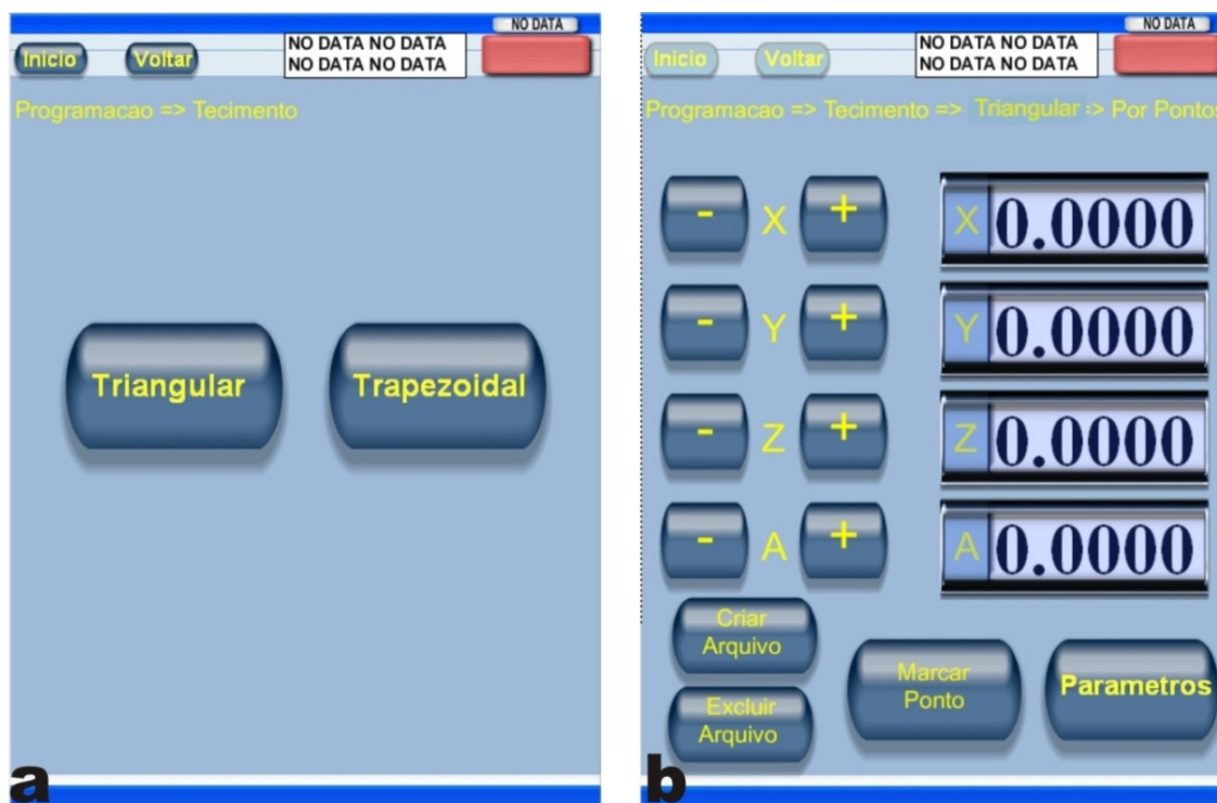
Figura 3-41 – Primeira IHM em ambiente Flash. Em (a) tela para seleção da forma de tecimento e em (b) captura de pontos
