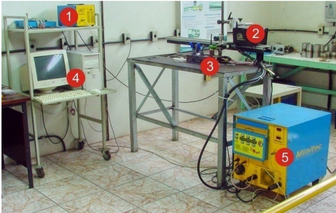
Figura 5.4 – Bancada de desenvolvimento. Em (1) Unidade de controle, em (2) Carro do Tartílope, em (3) Mesa de soldagem, em (4) Computador equipado com a Interdata e em (5) Fonte de soldagem Minitec 200
