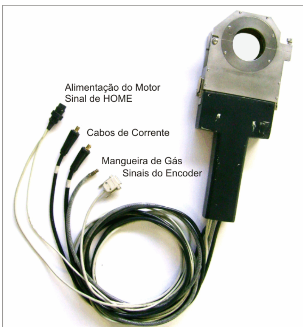
Figura 4.5 – Cabeçote orbital com o mangote instalado
