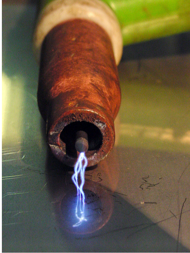
Figura 2.5 – Centelhas produzidas por um circuito de alta frequência
