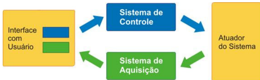
Figura 3.1 – Disposição Conceitual do Sistema Avançado de Controle
