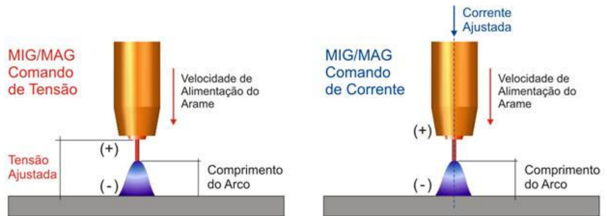
Figura 4.1 – Comparativo do processo MIG/MAG
