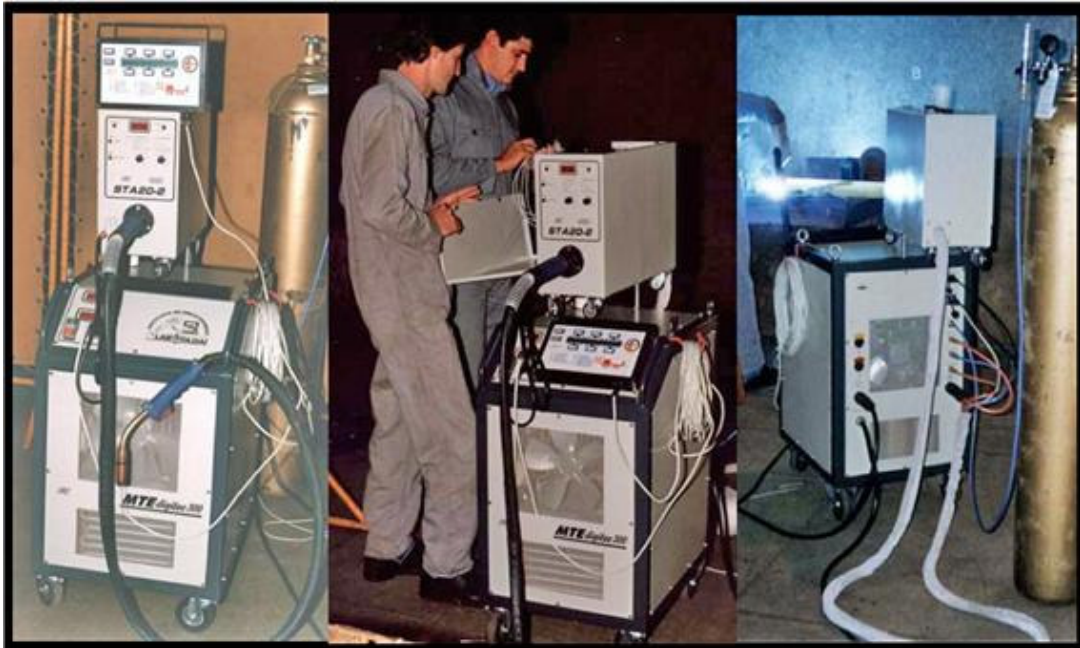
Figura 2.9 – Fonte de soldagem MTE Digitec em operação
