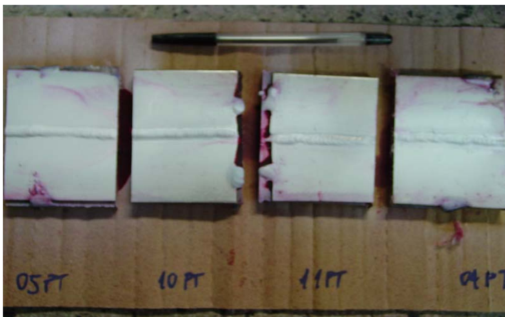
Figura 54 – Ausência de trincas e poros após ensaio por líquido penetrante para o MAG-PT
