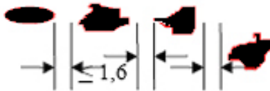
Figura 30 – Critério de aceitação para porosidades com indicações em linha separada
