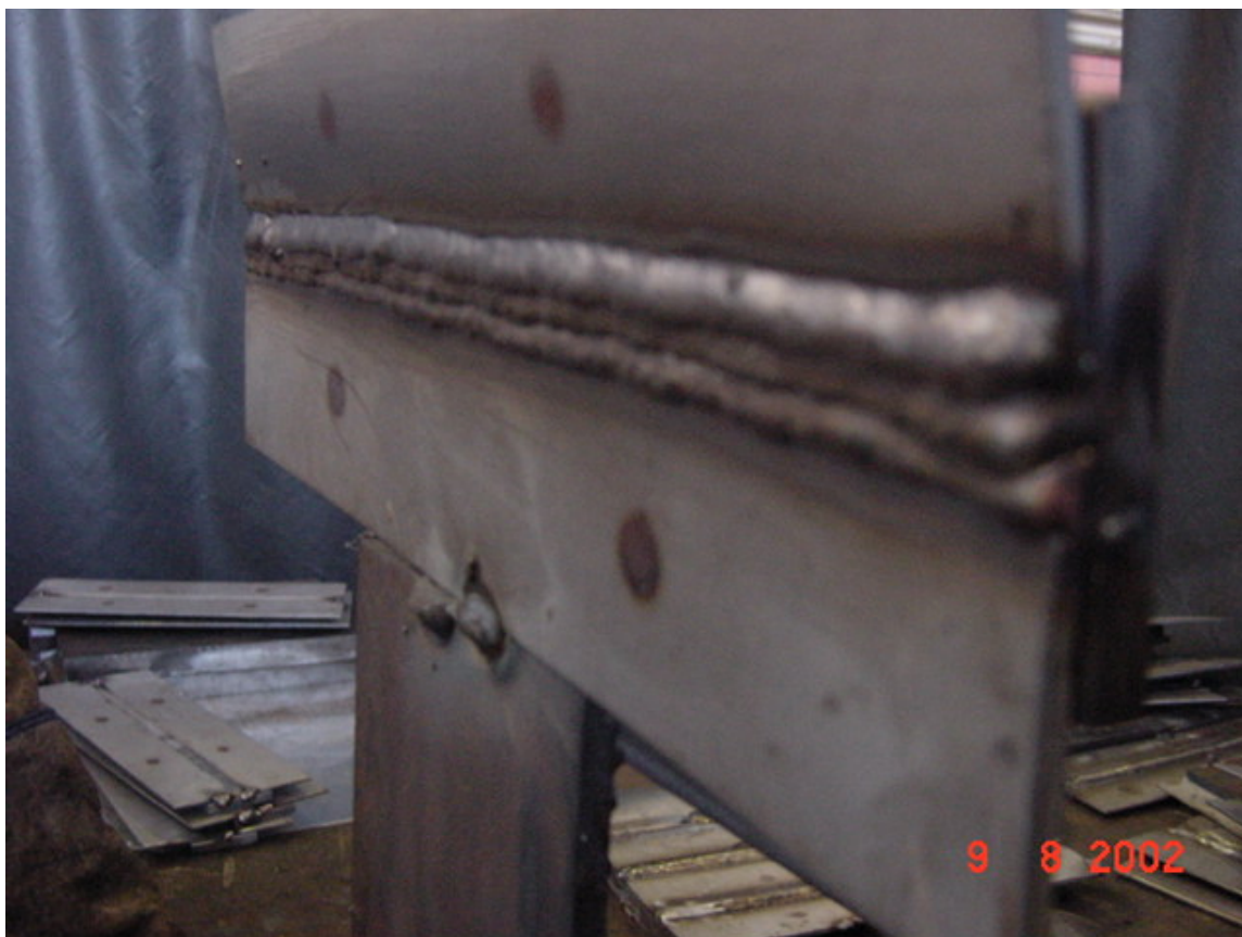
Figura 13 – Aspecto do cordão de solda obtido atualmente pelo processo MAG com arame tubular e gás de proteção com 80 % Ar e 20 % CO 2 (Balducci et al., 2004)
