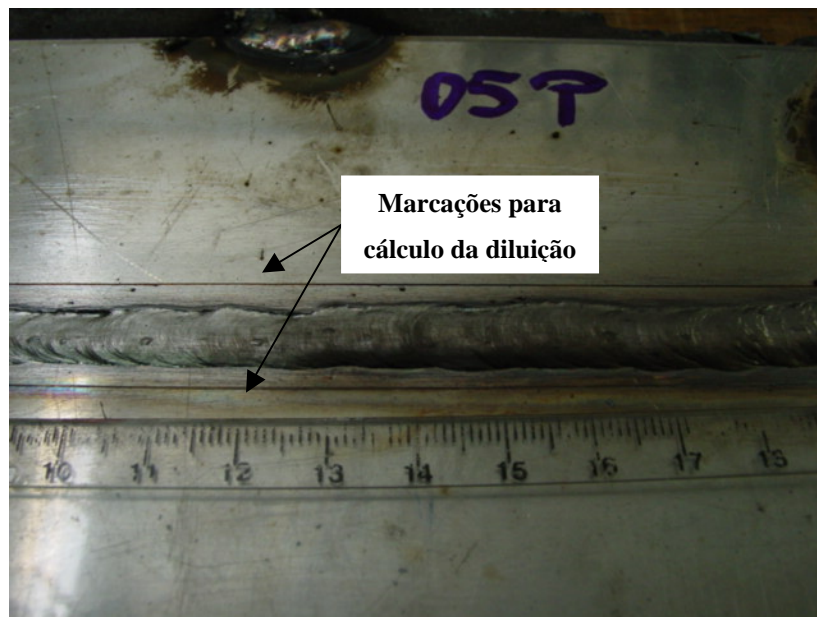
Figura 24 – Corpo de prova marcado para cálculo da diluição
