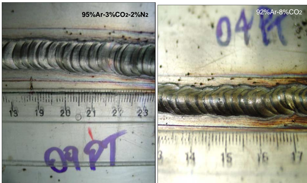
Figura 38 – Aspecto do cordão de solda – MAG-PT com comprimento do eletrodo de 15 mm
