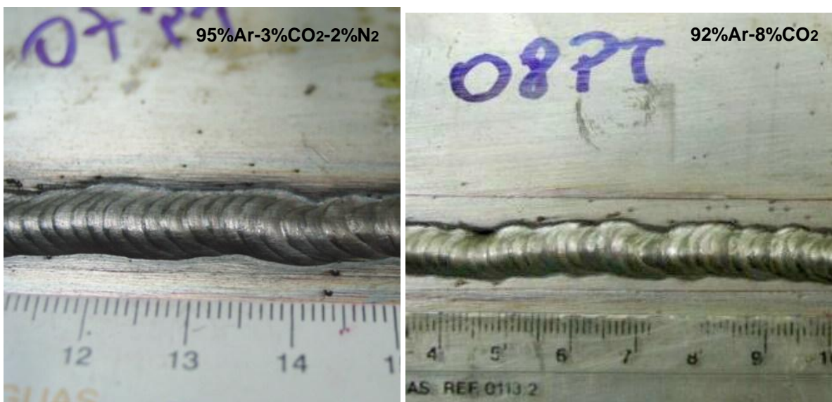
Figura 34 – Cordão de solda - MAG-PT com comprimento do eletrodo de 10 mm
