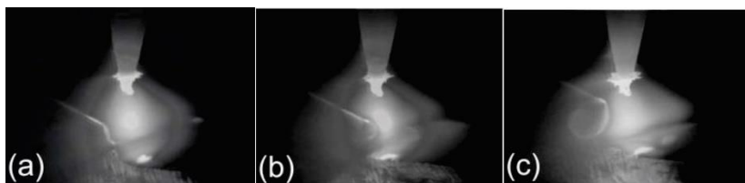
Figura 2.6 – Modos de transferência metálica de arame maciço no processo TIG [26]: a) ponte metálica com 65°; b) transferência intermitente com 66,5 °; c) transferência intermitente grosseira com 68,5°
