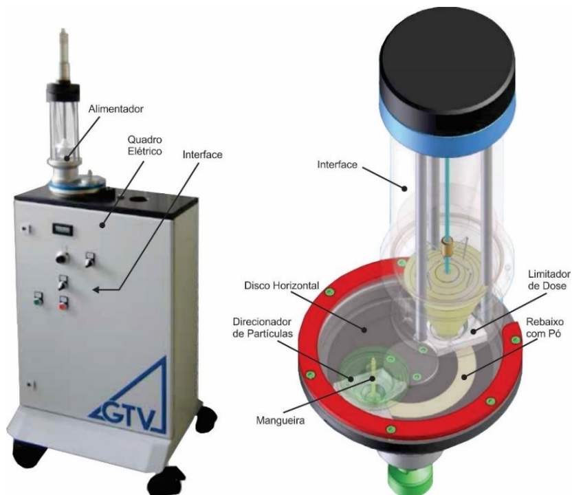
Figura 2.44 – Alimentador de pó tipo Disco horizontal [73]
