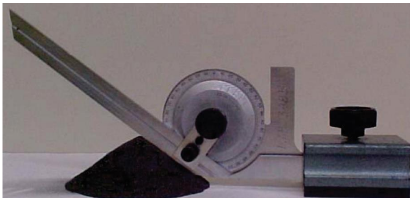
Figura 4.4 – Medição do ângulo de empilhamento dos pós [13]
