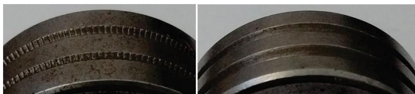
Figura 2.15 – Tipos de roletes: a) sulcos ranhurados; b) sulcos lisos
