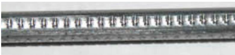
Figura 2.16 – Impressões provocadas por roletes ranhurados em arame tubular
