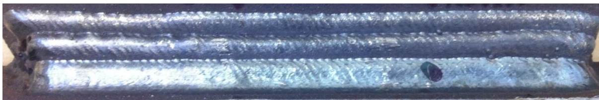
Figura 22. Resultado do ensaio efetuado com o processo FCAW na posição de soldagem horizontal
