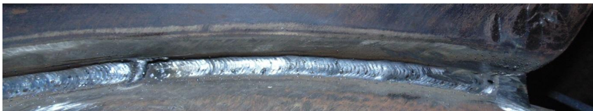
Figura 37. Passe de raiz soldado na peça com curvatura enviada pela empresa
