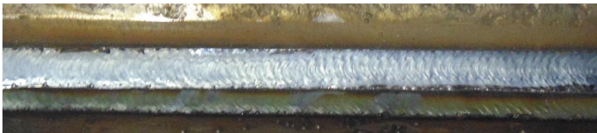
Figura 36. Aspecto superficial dos cordões soldados na posição vertical descendente
