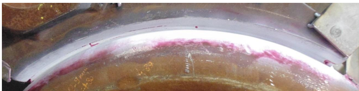
Figura 38. Ensaio de líquido penetrante realizado no verso da raiz
