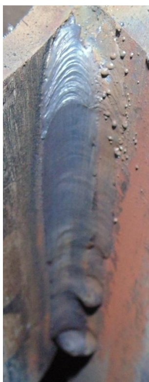
Figura 30. Aspecto superficial dos cordões realizados na posição vertical descendente
