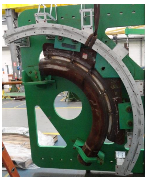
Figura 2. Trilho de movimentação do sistema de deslocamento automatizado fixado ao gabarito de posicionamento das peças
