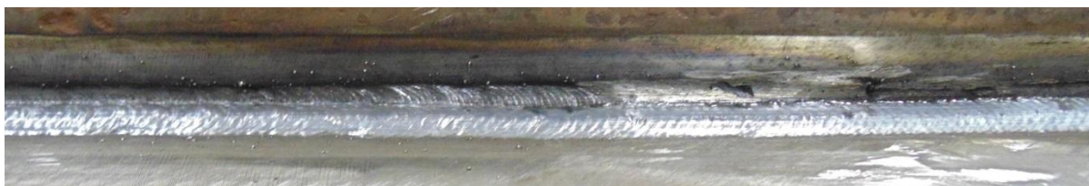
Figura 41. Passe de enchimento soldado com o processo MIG/MAG pulsado adaptativo - IMC
