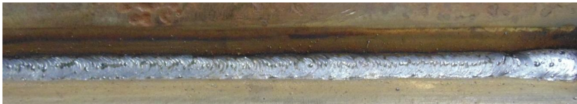
Figura 40. Passe de raiz soldado com o processo MIG/MAG convencional
