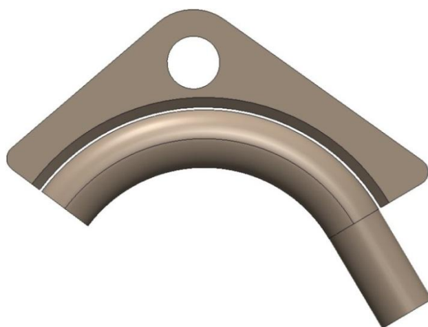
Figura 31. Novo posicionamento da peça cogitado para a eliminação da posição vertical descendente
