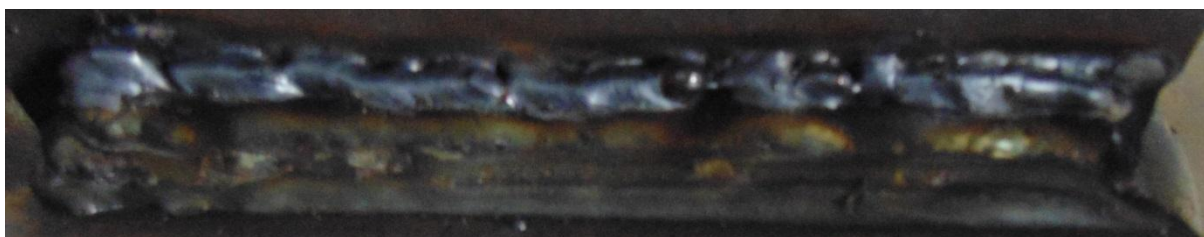
Figura 32. Aspecto visual dos cordões efetuados na posição inclinada 45° ascendente
