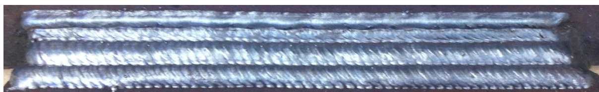
Figura 19. Aspecto visual do corpo de prova soldado com RMD na posição horizontal
