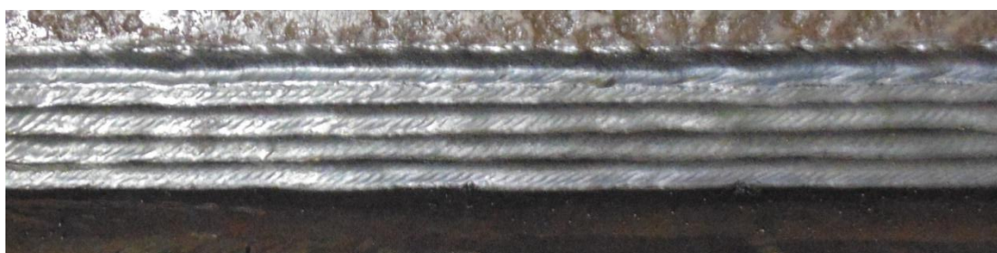
Figura 34. Aspecto visual dos cordões soldados na posição inclinada 45° ascendente
