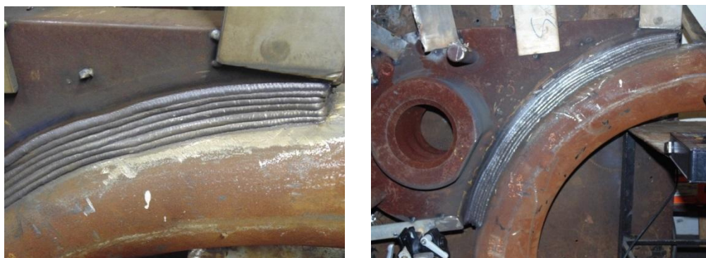
Figura 39. Passes de enchimento soldados na peça com curvatura enviada pela empresa
