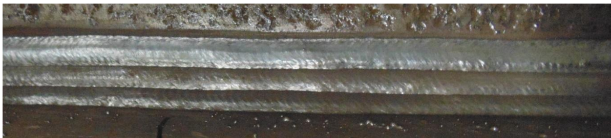
Figura 35. Aspecto visual dos cordões soldados na posição inclinada 45° descendente
