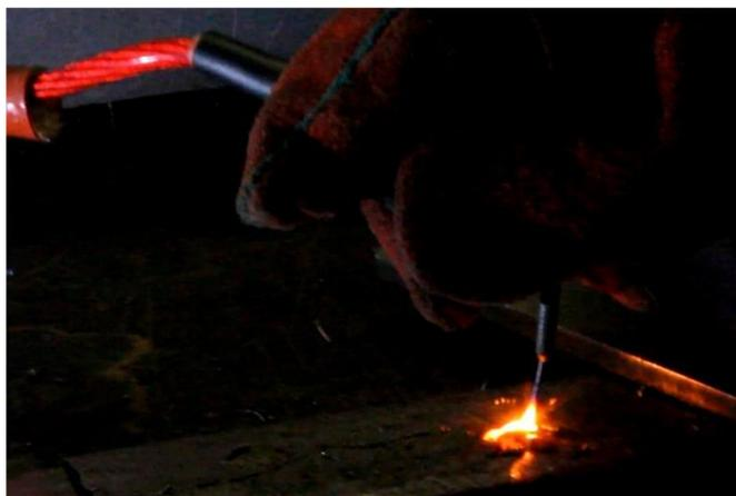
*Figura 29 – Alimentação de arame sem a ação do arco voltaico, evidenciando o aspecto incandescente resultante do pré-aquecimento.*
