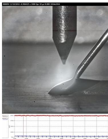
*Figura 56 - Filmagem em alta velocidade dos procedimentos de soldagem utilizando alimentação de arame por trás do arco, Cold Wire, alimentação dinâmica (18 Hz) e formas de transferência por ponte.*
