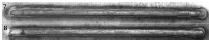
*Figura 35 - CP 07 e 08. Procedimentos realizados com alimentação de arame por trás do arco, Hot Wire, alimentação contínua e transferência metálica por destacamento.*
