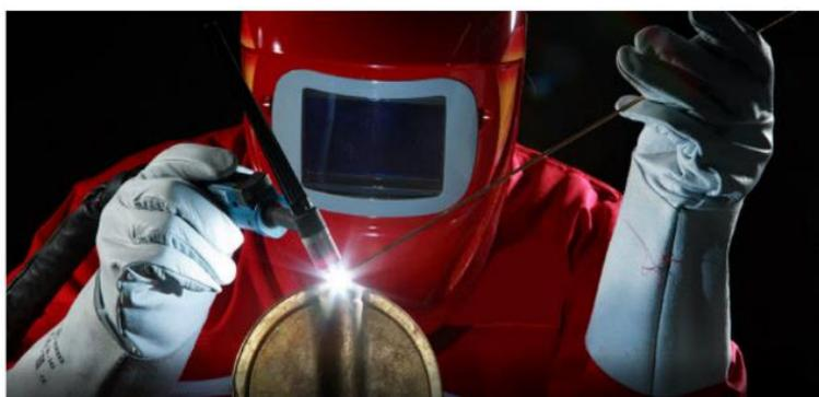
*Figura 5 - Soldador executando soldagem TIG com a utilização de alimentação de arame de forma manual.*
