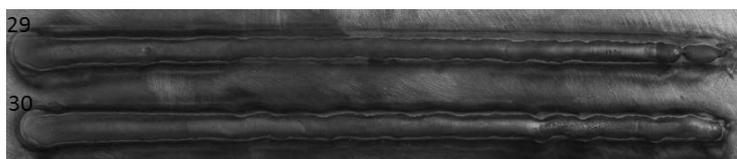
*Figura 44 - CP 29 e 30. Procedimentos realizados com alimentação de arame pela frente do arco, Cold Wire, alimentação contínua e transferência metálica por ponte.*
