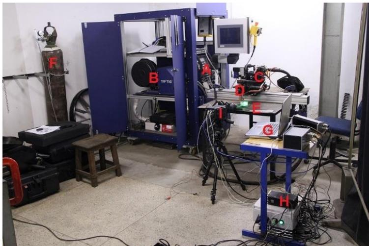
*Figura 16- Bancada de ensaios utilizada para os ensaios com alimentação dinâmica e contínua com aquisição de dados e filmagem em alta velocidade. A) Fonte de Soldagem, B) Tracionador de Arame, C) Manipulador robótico, D) Tocha de soldagem e dispositivo de alimentação de arame, E) Corpo de prova, F) Gás de proteção, G) Software para aquisição de filmagem em alta velocidade, H) Dispositivo para aquisição de dados, I) Câmera de alta velocidade.*
