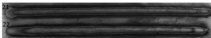
*Figura 40 - CP 21 e 22. Procedimentos realizados com alimentação de arame pela frente do arco, Hot Wire, alimentação contínua e transferência metálica por ponte.*
