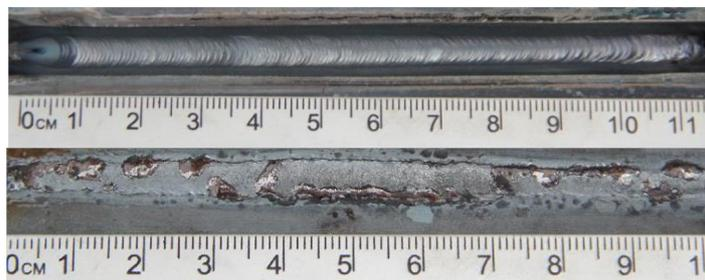
*Figura 84 – Procedimento de raiz realizado com processo TIG com alimentação contínua de arame.*
