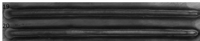
*Figura 39 - CP 19 e 20. Procedimentos realizados com alimentação de arame pela frente do arco, Hot Wire, alimentação dinâmica (18 Hz) e transferência metálica por destacamento.*
