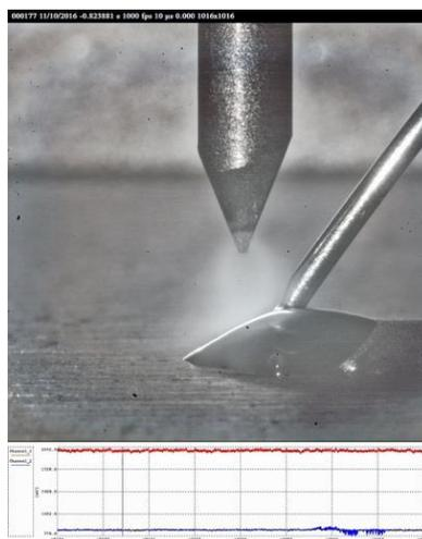
*Figura 57 - Filmagem em alta velocidade dos procedimentos de soldagem utilizando alimentação de arame por trás do arco, Cold Wire, alimentação contínua e formas de transferência por ponte.*
