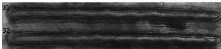
*Figura 45 - CP 31 e 32. Procedimentos realizados com alimentação de arame pela frente do arco, Cold Wire, alimentação contínua e transferência metálica por destacamento.*
