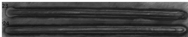
*Figura 41 - CP 23 e 24. Procedimentos realizados com alimentação de arame pela frente do arco, Hot Wire, alimentação contínua e transferência metálica por destacamento.*
