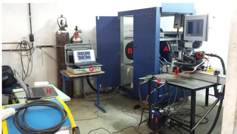
*Figura 15 - Bancada de ensaios utilizada para os ensaios com alimentação dinâmica e contínua com aquisição de dados e filmagem térmica. A) Fonte de Soldagem, B) Tracionador de Arame, C) Manipulador robótico, D) Tocha de soldagem e dispositivo de alimentação de arame, E) Corpo de prova, F) Gás de proteção, G) Sistema de aquisição de dados SAP, H) Software para aquisição de filmagem térmica, I) Câmera Infravermelha.*
