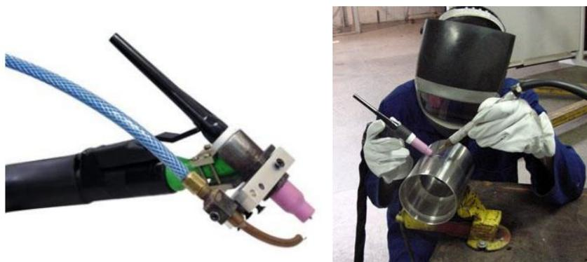
*Figura 4 - Tochas de soldagem TIG realizadas com alimentação de arame automática, com o uso de dispositivos acoplados e não acoplados á tocha de soldagem, respectivamente.*
