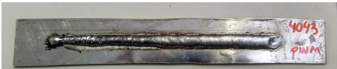
Figura 43 - Cordão nº1, arame de alumínio ER4043, com 1,2 mm de diâmetro, controle PWM.
