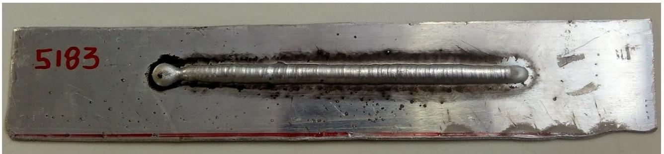
Figura 47 - Cordão nº4, arame de alumínio ER5183, com 1,2 mm de diâmetro, controle valores extremos.
