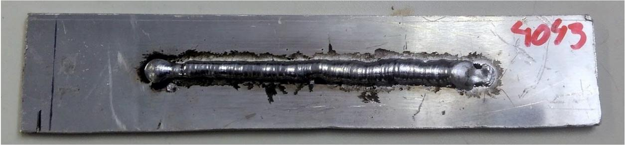
**Figura 44 - Cordão nº2, arame de alumínio ER4043, com 1,2 mm de diâmetro, controle valores extremos.**
