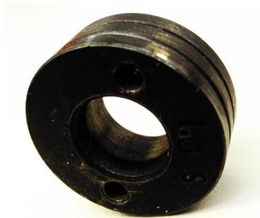
Figura 18 - Rolete utilizado para deslocamento de arame.
