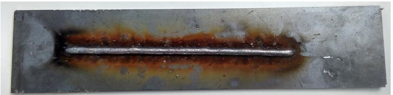
**Figura 45 - Cordão nº3, arame de aço ER70S-6, com 1,2 mm de diâmetro, controle valores extremos.**
