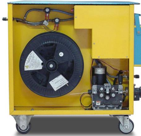
Figura 28 - Cabeçote alimentador de arame [18].
