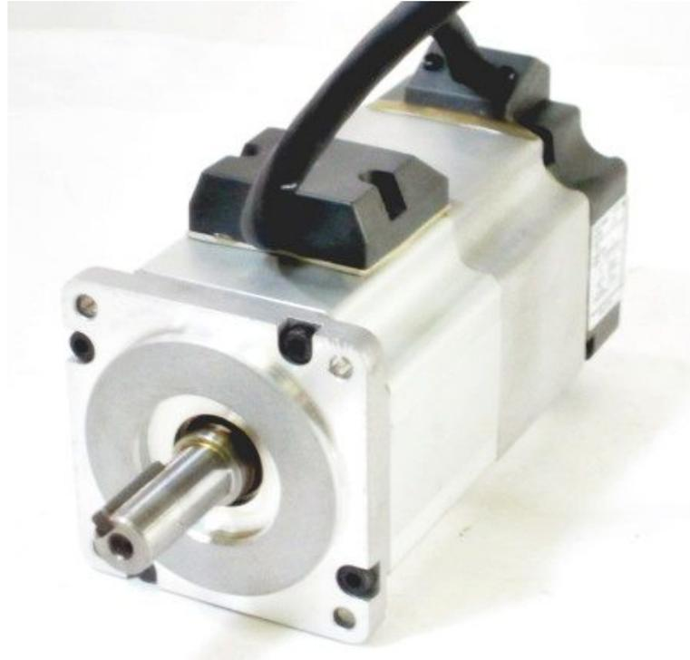
**Figura 15 - Servomotor utilizado nos estudos e testes.**
