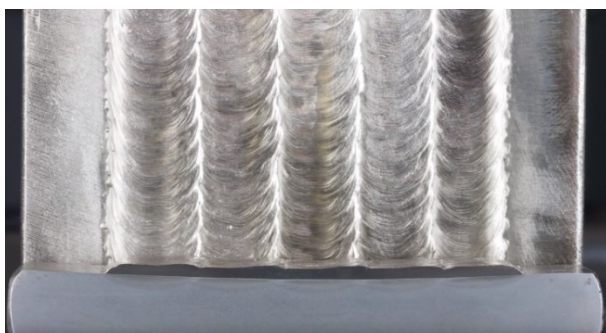
Figura 5: Revestimento realizado pela tocha MA-400 sobre uma chapa de aço. Percebe-se diluição muito baixa e boa qualidade superficial dos cordões. (Weld Revolution, 2015)
