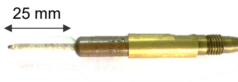
Figura 20: “Teach tip”: Bico de contato com arame de 25 mm fixado a sua ponta. Pintado de branco para auxiliar na medição
