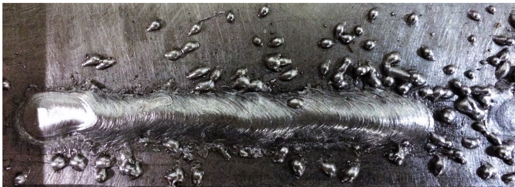
Figura 26: Cordão de solda com deposição extremamente irregular devido a rotação do eletrodo. Arame ER-70S-6 sobre chapa de aço 1020. V_t = 2500 rpm.
