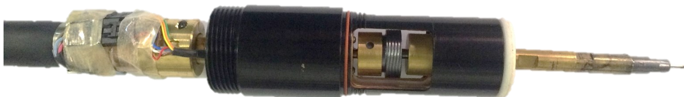
Figura 17: Tocha MA-400 sem suas proteções estruturais.
