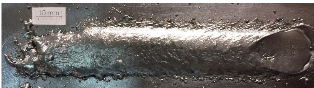
Figura 25: Cordão de solda realizado com a tocha MA-400. V_t = 1200 rpm
