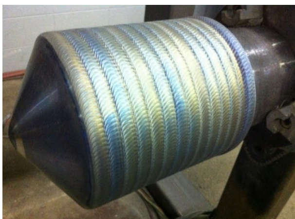
Figura 4: Peça com revestimento metálico por processo de soldagem. (Taskmaster-inc, 2016)
