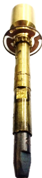
Figura 13: Conjunto eixo secundário/ bico de contato com extensor. A mola plana feita em cobre é fixada no eixo secundário.
