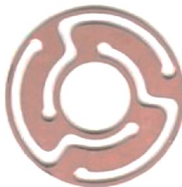
Figura 14: Pivô. Mola plana em liga de Cobre. Permite movimento de rotação cônico do eixo agindo também como amortecedor do sistema.
