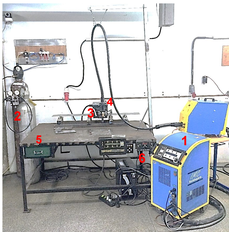
Figura 10: Bancada de soldagem.
