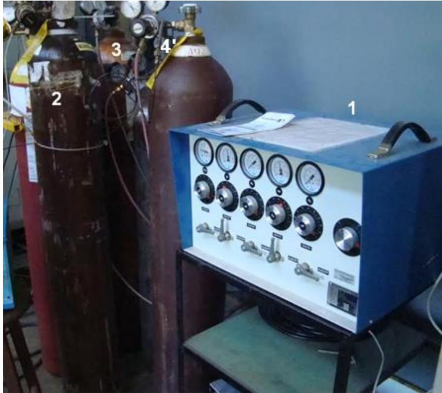
Figura 9 – 1) Misturador de Gases WITT KM 30-5; 2) Cilindro contendo Argônio puro; 3) Cilindro contendo Hélio puro; 4) Cilindro contendo Dióxido de Carbono
