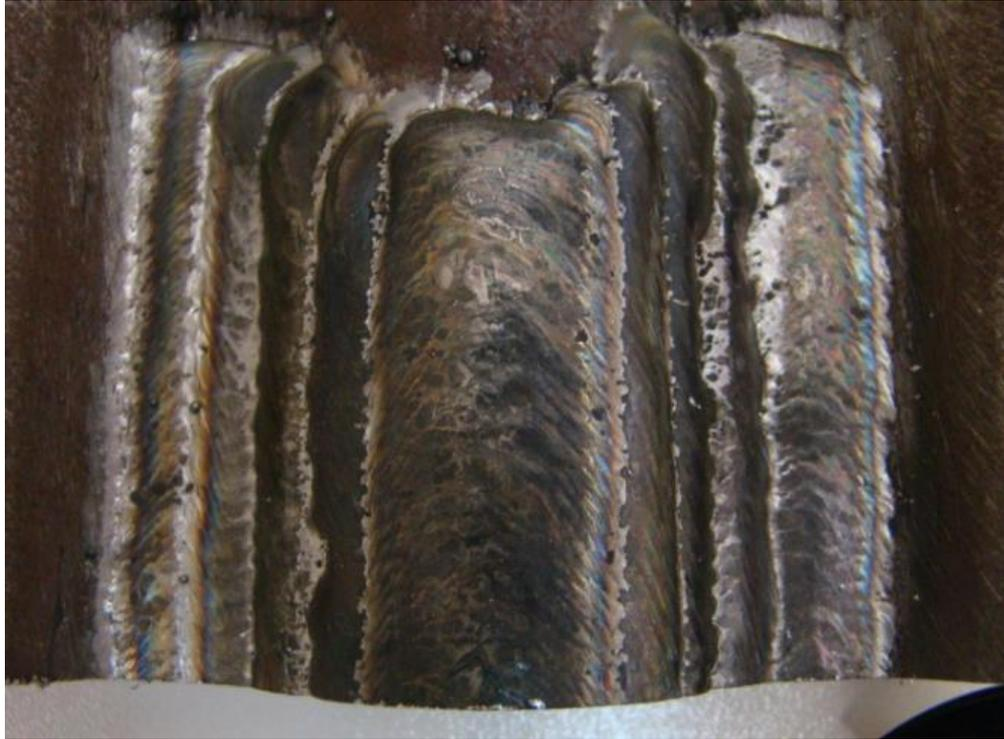
Figura 18 – Revestimento resultante do procedimento desenvolvido com arame de 1,0 mm
