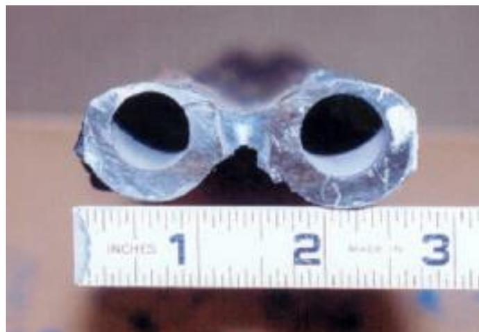
Figura 1 – Exemplo de tubos deteriorados devido a erosão e corrosão [2]
