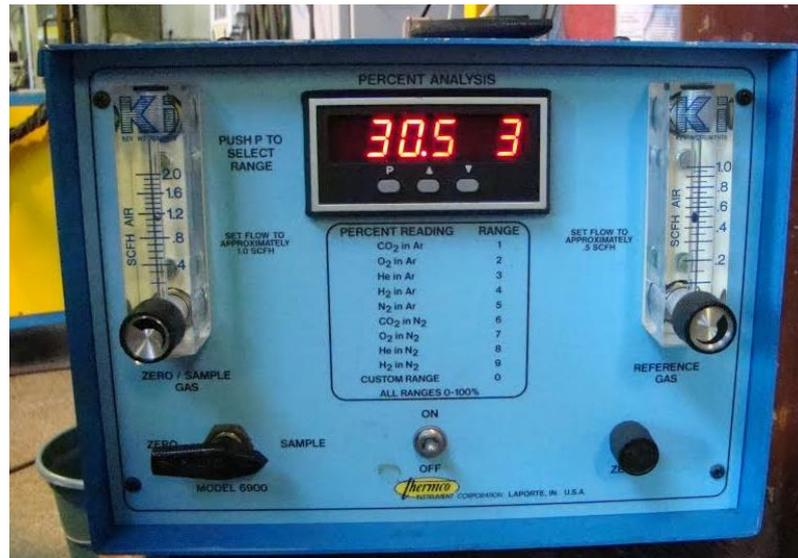
Figura 10 – Analisador de misturas binárias da empresa THERMCO, modelo 6900
