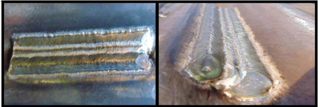
Figura 22 – Revestimento constando dos cordões ‘Membrana’, ‘Junção’ e ‘Lateral 1’
