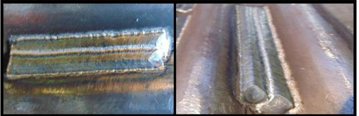
Figura 21 – Revestimento constando dos cordões ‘Membrana’ e ‘Junção’
