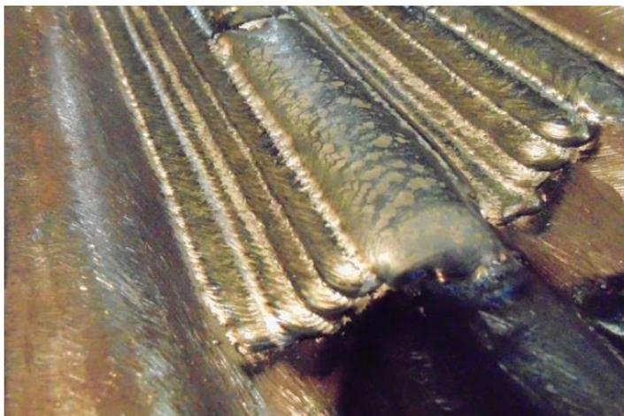
Figura 24– Revestimento finalizado, constando de todos os cordões em ambos os lados do tubo
