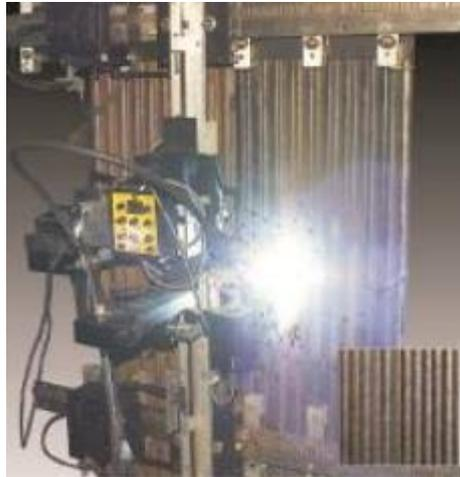
Figura 2 - Soldagem automatizada para o revestimento de paredes de caldeiras
