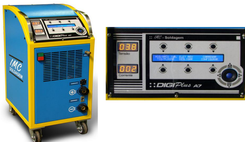
Figura 19 – Fonte de soldagem IMC Digiplus A7 e detalhe do teclado.
