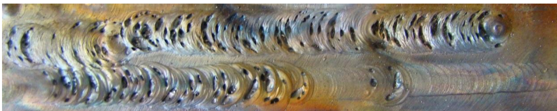
Figura 23 – Cordões de solda com formação de poros realizados com a tocha PP-6-01.
