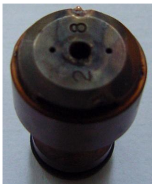
Figura 4 – Bico de contato plasma com furos auxiliares.
