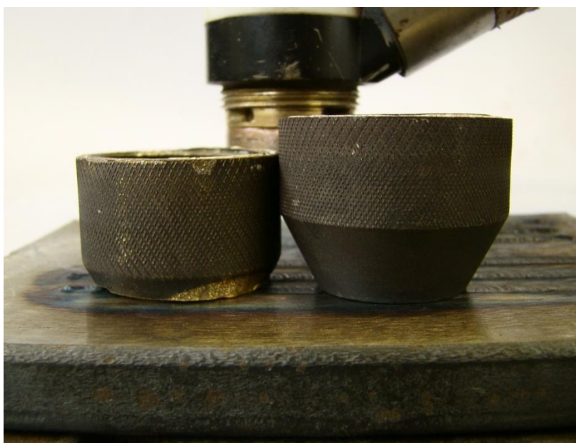
Figura 20 – Bocal cortado à esquerda para possibilitar a soldagem com pequenas distâncias entre tocha e chapa.
