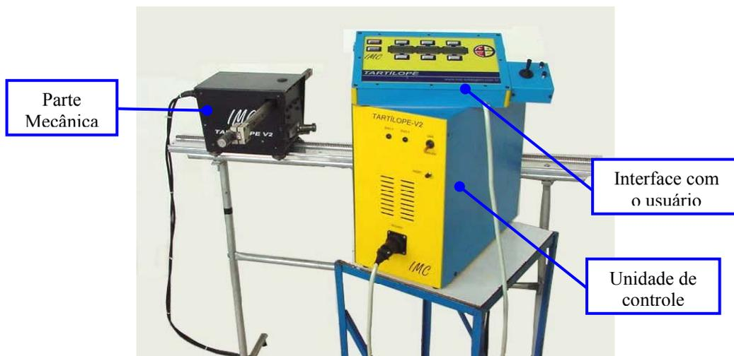
Figura 1. Sistema de deslocamento “Tartilope V2”.
