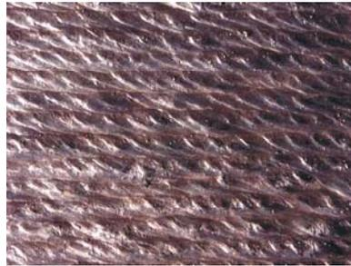
Figura 13. Superfície após receber adição de material no procedimento de recobrimento.
