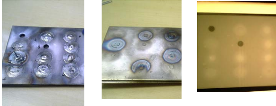
Figura 10 – Corpo de prova soldado com o procedimento para a 3ª versão do duplo ponto.
