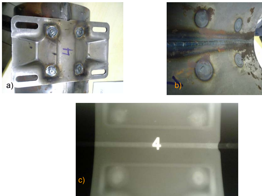
Figura 15 – a) Face, b) penetração e c) fusão em soldagem na posição plana.
