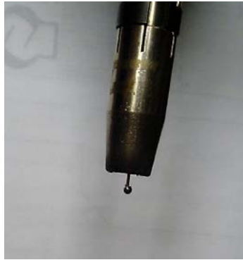
Figura 14 – Gota grande solidificada na ponta do arame ao final do primeiro ponto.
