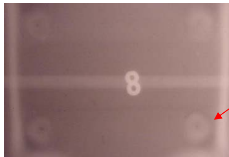
Figura 6 - Radiografia que indica existência de poros.
