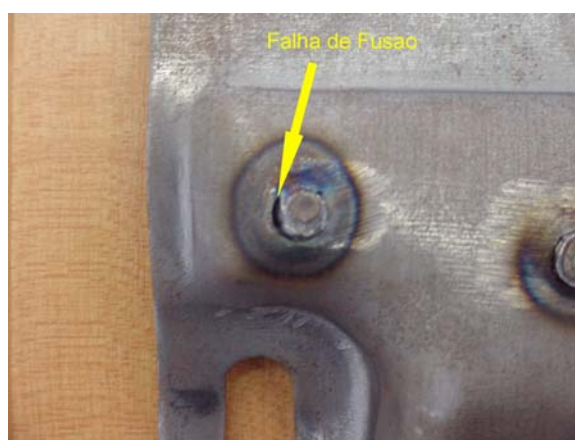
Figura 2 – Foto do pé do motor elétrico após ensaio de tração.
