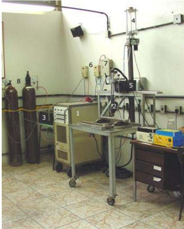
1-Fonte de soldagem; 2-Tocha; 3-Modulo plasma; 4-Alimentador de pó; 5-Sistema de deslocamento da tocha; 6-Medidores digitais de gases; 7-Válvula eletrônica de gás; 8-gases
