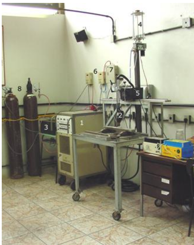
1-Fonte de soldagem; 2-Tocha; 3-Modulo plasma; 4-Alimentador de pó; 5-Sistema de deslocamento da tocha; 6-Medidores digitais de gases; 7-Válvula eletrônica de gás; 8-gases
