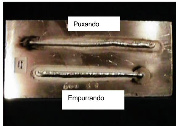
Fig. 5 Cordões de solda com corrente de pulso de 180 A
