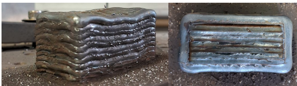
Figura 7. Peça sólida produzida com WAAM em 10 camadas: vista diag (esq.) e superior (dir.)
