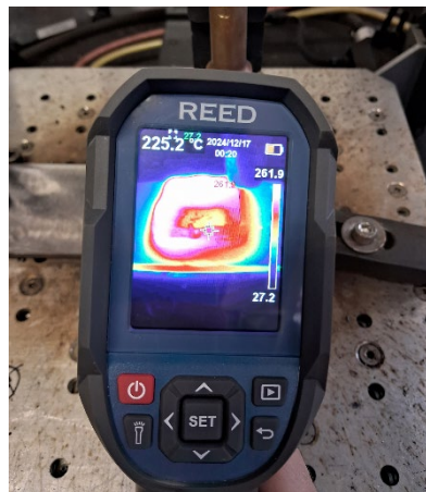
Figura 6. Termografia durante o interpasse da última camada
