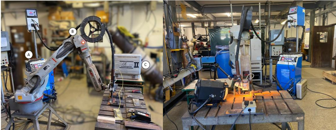
Figura 1. Bancada de experimentos utilizada para a realização dos ensaios: A- Fonte de soldagem IMC Digiplus A7; B- robô antropomórfico Yaskawa Motoman XRC UP6; C- Sistema de aquisição de variáveis de soldagem portátil (SAP).
