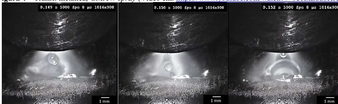
Figura 4 – Transf. metálica, GMAW spray (Vídeo em: https://www.youtube.com/watch?v=93HxESz8HXw )
