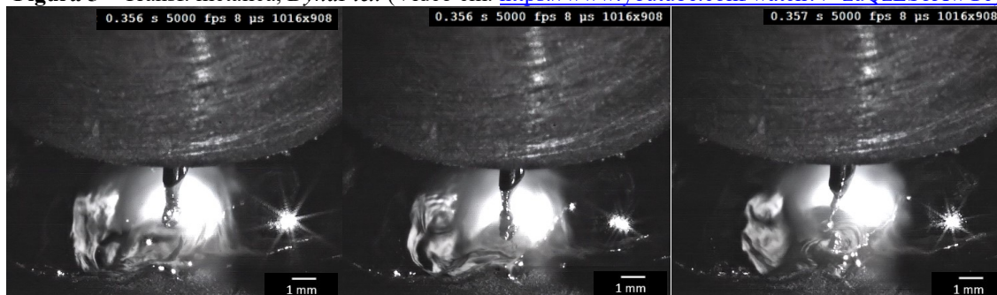
Figura 5 – Transf. metálica, DynaFlex (Vídeo em: https://www.youtube.com/watch?v=zuQzESoAwGc )
