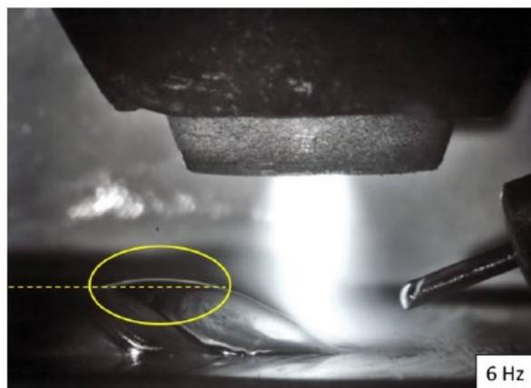
Figura 9. Momento em que uma porção de metal líquido está no topo da poça a uma altura maior que o cordão já solidificado. Soldagem com frequência de 6 Hz. ([Hyperlink para Vídeo](#))
