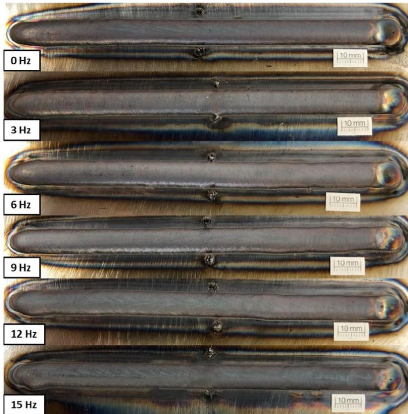
Figura 6. Resultado visual, vista superior, dos cordões soldados para as diferentes frequências de alimentação de arame.
