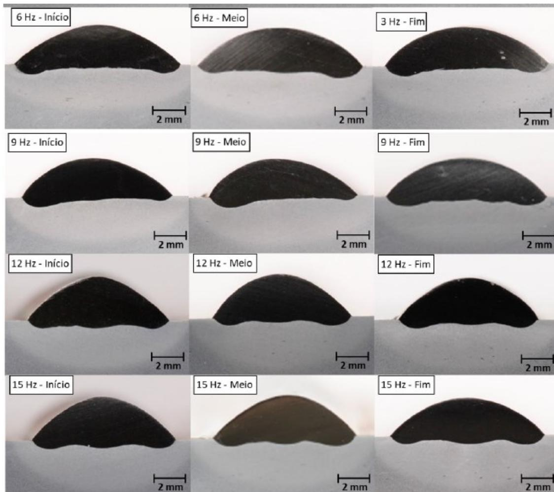
Figura 7. Resultados do corte transversal dos cordões para as diferentes frequências de alimentação
