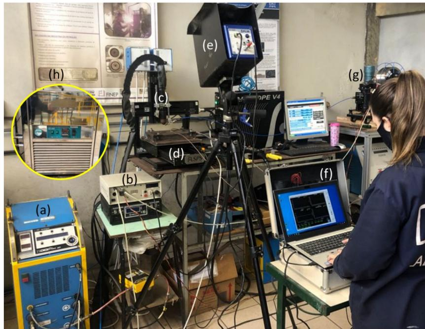
Figura 1. Bancada de ensaios: (a) Fonte de energia, (b) controlador do módulo de alimentação dinâmica, (c) tocha plasma, (d) manipulador robótico, (e) câmera térmica, (f) sistema de aquisição portátil (SAP), (g) módulo de alimentação dinâmica (MAD)
