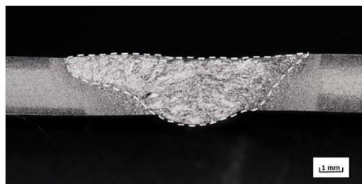
Figura 13. Macrografia de soldagem com backing aquecido.
