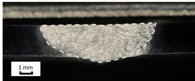
Figura 10. Macrografia de soldagem com tocha inclinada em  $35^\circ$ .
