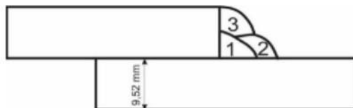
Figura 3 – Representação da sequência de soldagem.
