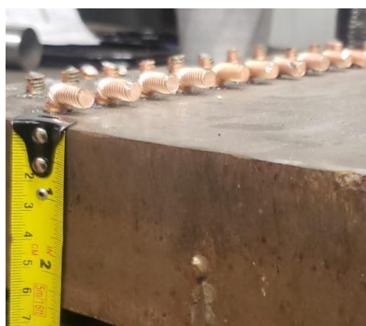
Figura 3 – Pinos M8 soldados na chapa de 63,5 mm de espessura após os testes de dobramento e de torque.
