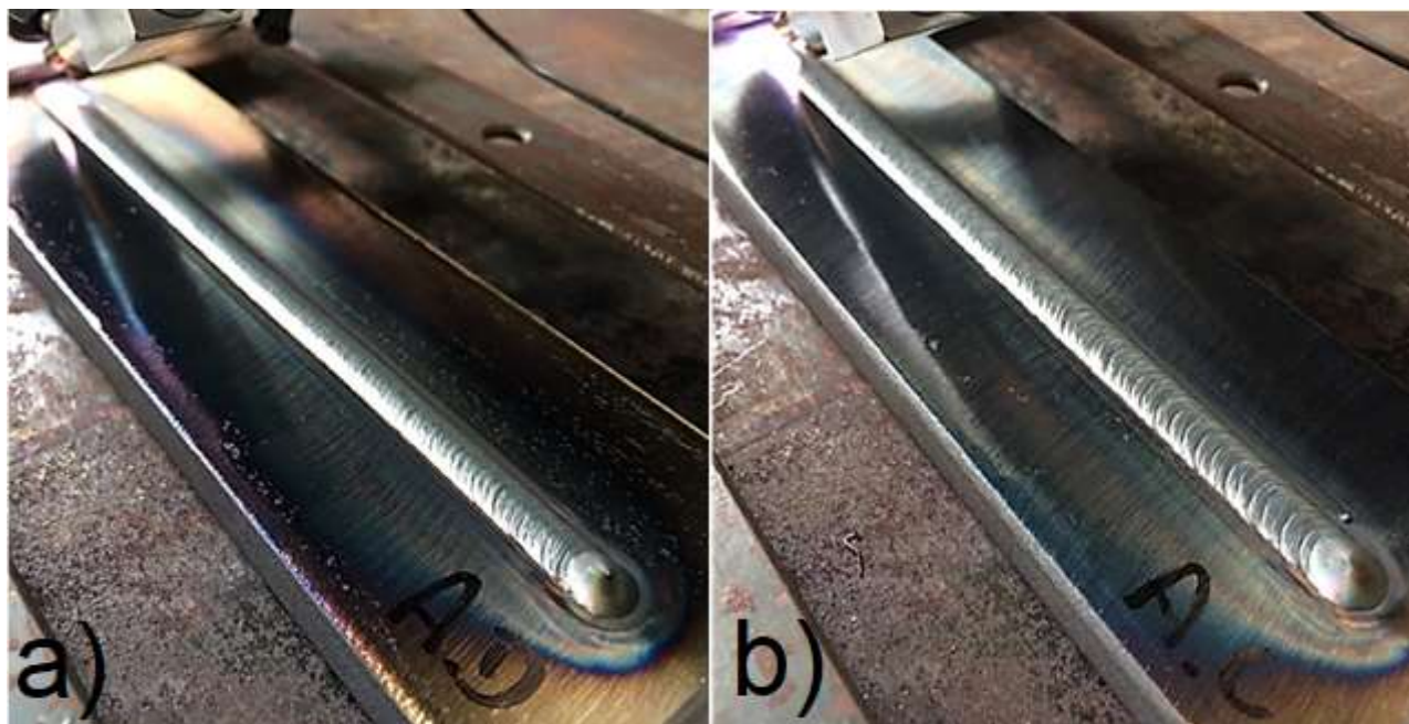
Figura 4. Aspecto superficial dos cordões de solda fabricados com (a) com alimentação dinâmica de arame e (b) com alimentação contínua de arame. Fonte: Autor.
