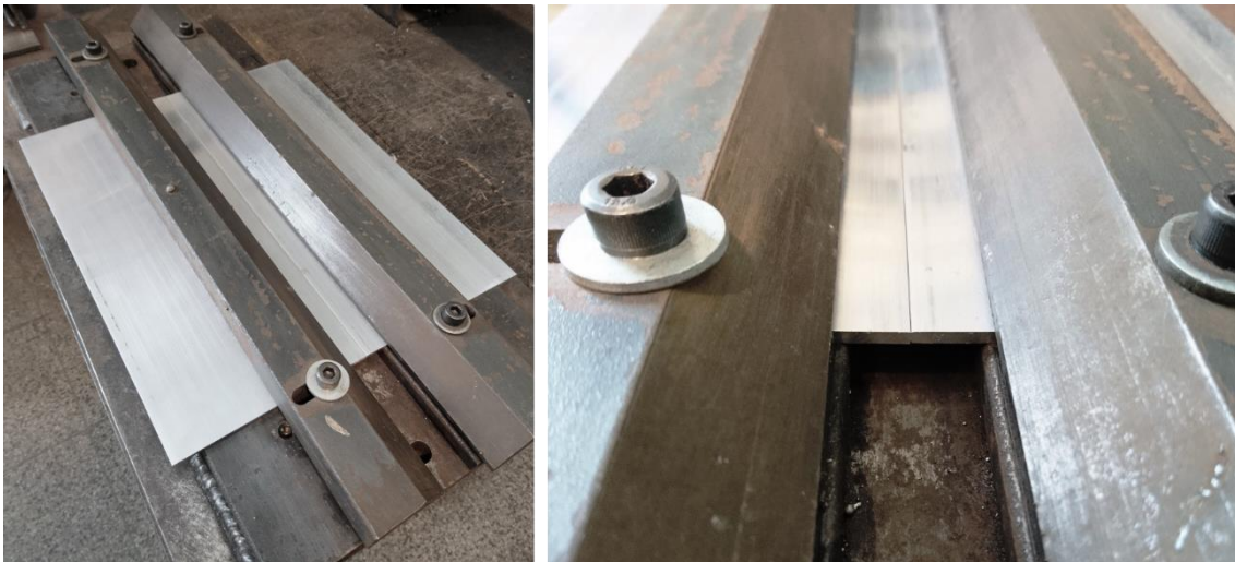
Figura 2 – Imagens do suporte construído para manter a posição dos corpos de prova durante a soldagem.
