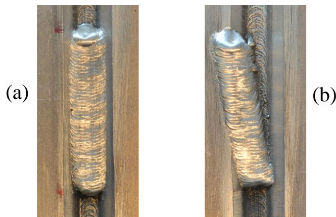
Figura 6: Cordões de solda sobre os corpos de prova constituídos pela liga de alumínio naval AlMg 5083 H116.
