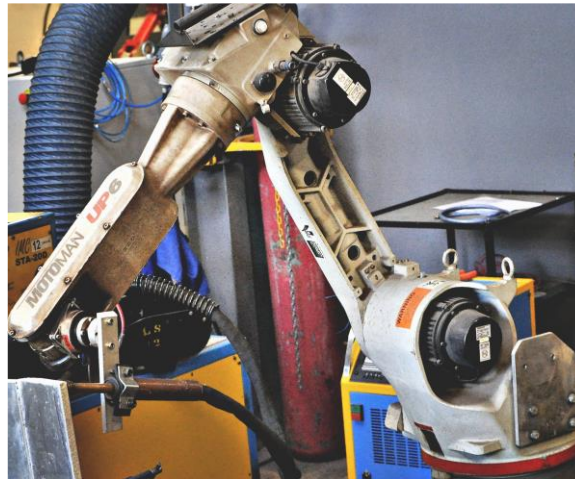
Figura 3: Robô antropomórfico MOTOMAN UP-6.
