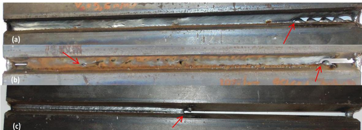
Figura 5. Face do passe de raiz. a) Condição P1. b) Condição sinérgica P2. c) Curto circuito.
