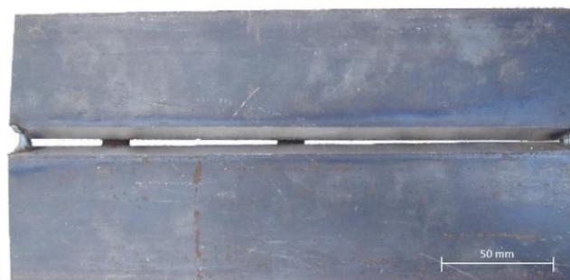
**Figura 2. Corpo de prova utilizado nos ensaios.**
