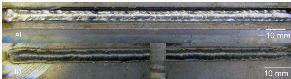
Figura 7.12. Aspecto superficial (A) e de raiz (B) para união utilizando o processo STT manual ascendente
