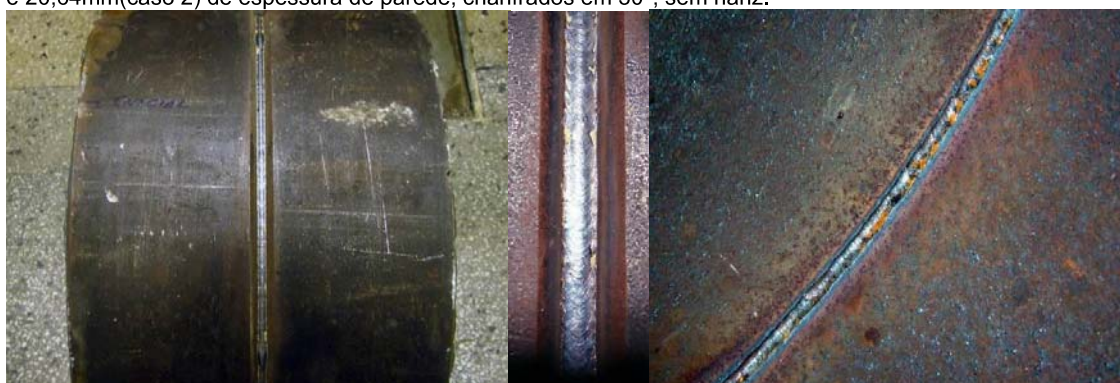
Figura 7.17. Imagens dos cordões obtidos com o processo CCC, caso 1.
