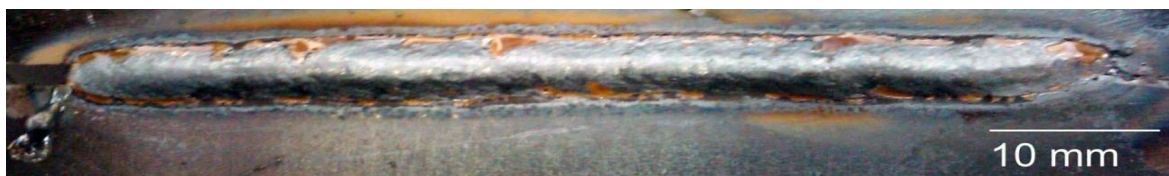
Figura 7.13. Aspecto superficial (C) e de raiz (D) para união utilizando o processo CCC manual ascendente
