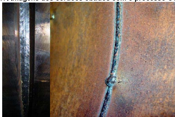
Figura 7.18. Imagens dos cordões obtidos com o processo CCC, caso 2.
