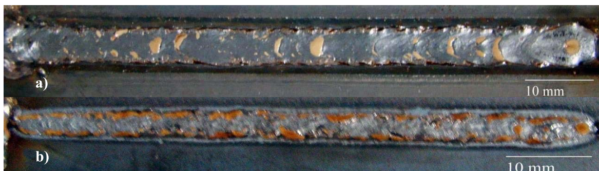
Figura 7.1. Aspecto superficial (a) e de raiz (b) para união utilizando o processo STT manual descendente
