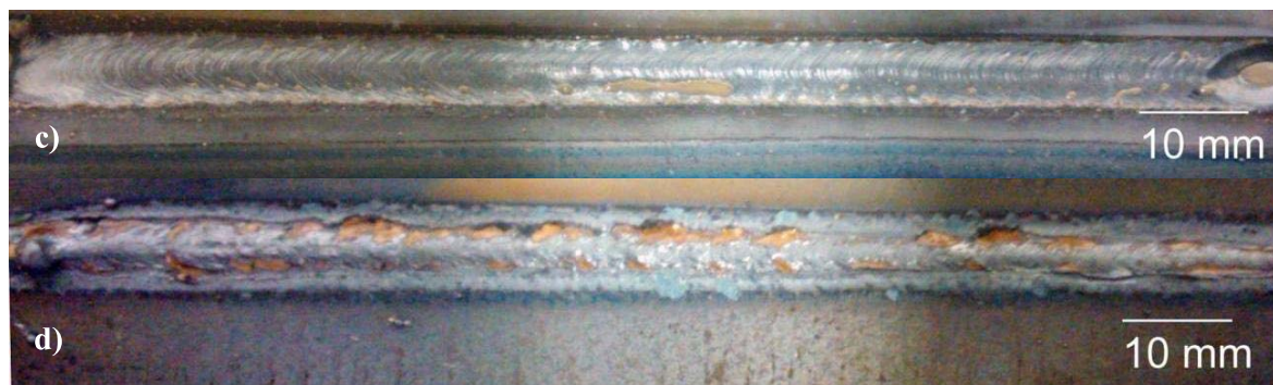
Figura 7.8. Aspecto superficial (c) e de raiz (d) para união utilizando o processo CCC Automatizado descendente
