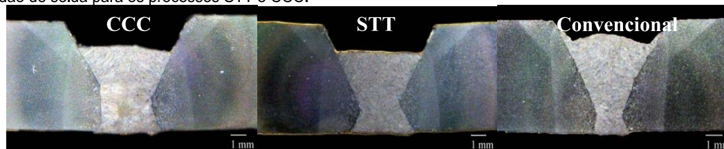
Figura 7.11. Macrografia da seção transversal dos cordões a, c e e.
