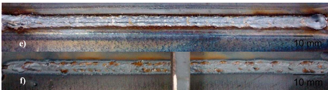
Figura 7.4. Aspecto superficial (e) e de raiz (f) para união utilizando o processo Convencional manual descendente
