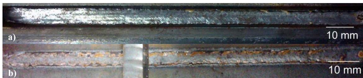
Figura 7.7. Aspecto superficial (a) e de raiz (b) para união utilizando o processo STT Automatizado Descendente
