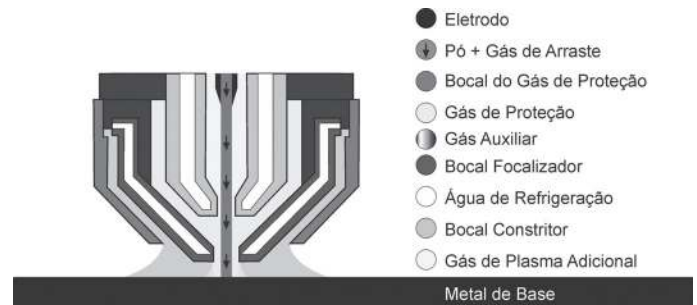
Figura 5. Tocha PTA-P com injeção central de pó (adaptado de [14])
