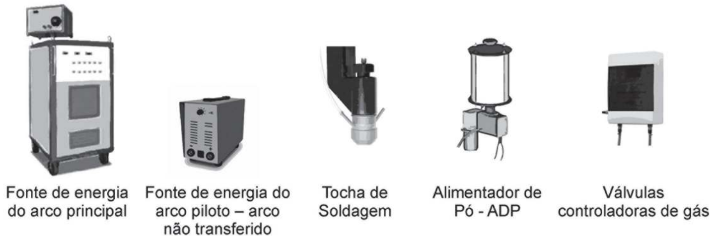
Figura 1. Esquema de um equipamento para soldagem PTA-P
