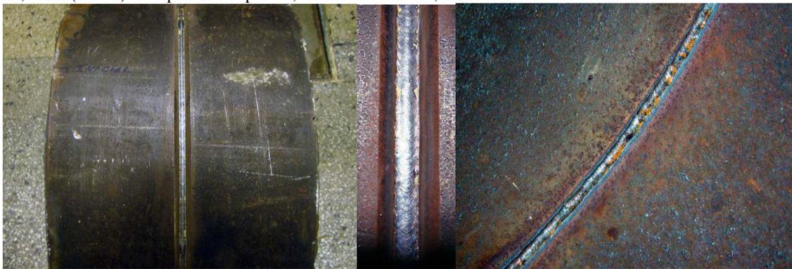
Figura 7.17. Imagens dos cordões obtidos com o processo CCC, caso 1.
