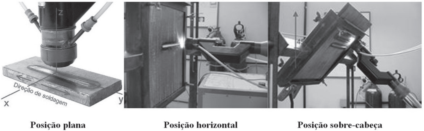
Figura 2. Fotos ilustrativas da posição da tocha para soldagem plana, horizontal e sobre-cabeça
