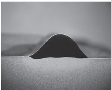
(a) Diluição = 4.3 % Gás de arraste: 2 l/min
