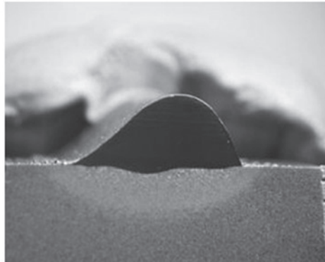
(b) Diluição = 7.5 % Gás de arraste: 4 l/min
