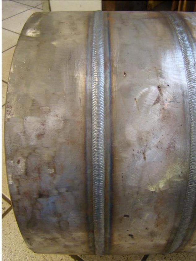
Figura 6. Cordão de solda realizado nos testes de soldagem orbital.
