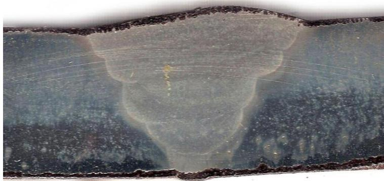
Figura 5. Exemplo de macrografia de um dos cordões de solda realizados nos testes experimentais.
