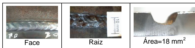
Figura 15. Soldagem 5G em bancada, cordão A, com pulsado de 0,24 Hz.
