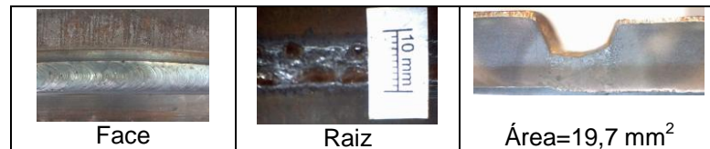
Figura 17. Soldagem 5G em bancada, cordão D, com pulsado de 5 Hz
