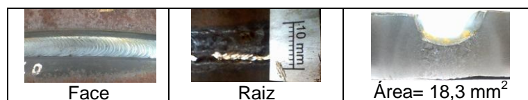
Figura 16. Soldagem 5G, cordão C, em bancada, com pulsado de 1 Hz.
